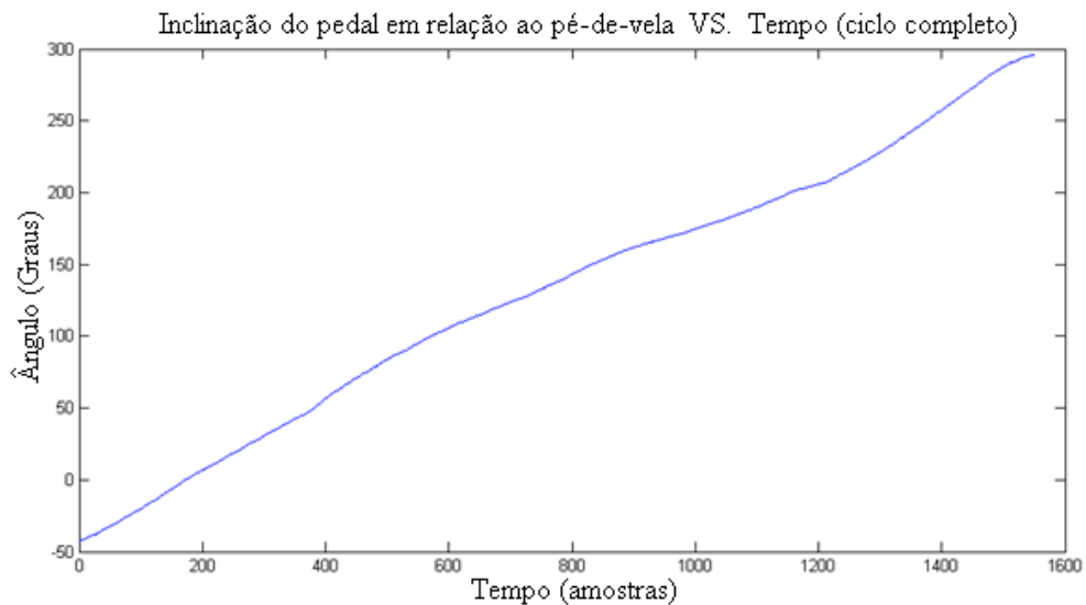
Figura 4.3: Inclinação do pedal em relação ao pé-de-vela. Comportamento típico da inclinação em um ciclo completo de pedalada na FIE.
