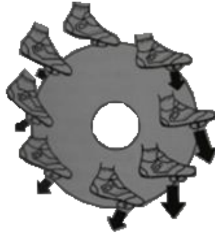
Figura 2.2: Ilustração das forças aplicadas ao pedal durante um ciclo de pedalada.
