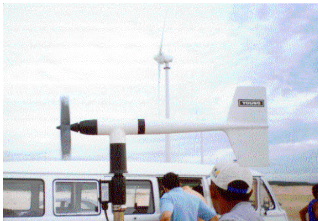
Figura 3.14 – Anemômetro utilizado nas medições da Taíba.
