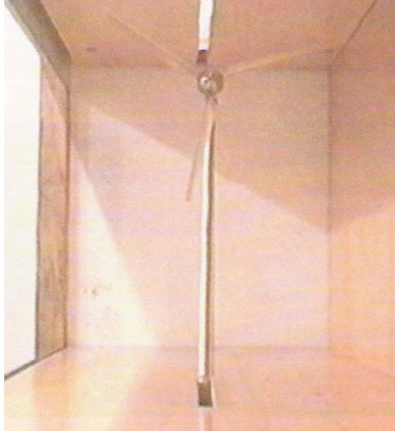
Figura 4.14 - Modelo reduzido do aerogerador montado no interior do túnel de vento.
