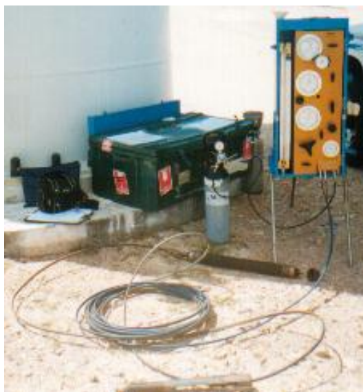
Figura 3.74 – Componentes do pressiômetro do tipo Ménard utilizado nos ensaios.
