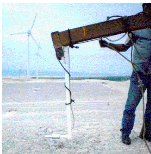
Figura 3.9 – Detalhe do anemômetro fixado à extremidade da lança do caminhão por meio de uma haste metálica.
