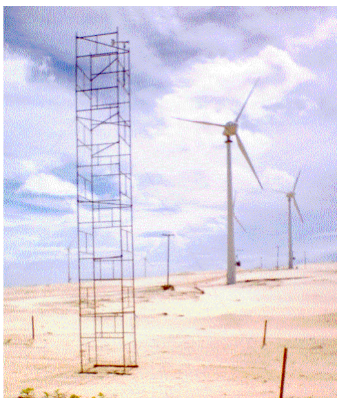
Figura 3.16 – Ensaaios anemométricos realizados a 10 m de altura.
