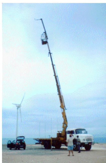
Figura 3.10 – Ensaios anemométricos realizados a 20m de altura.
