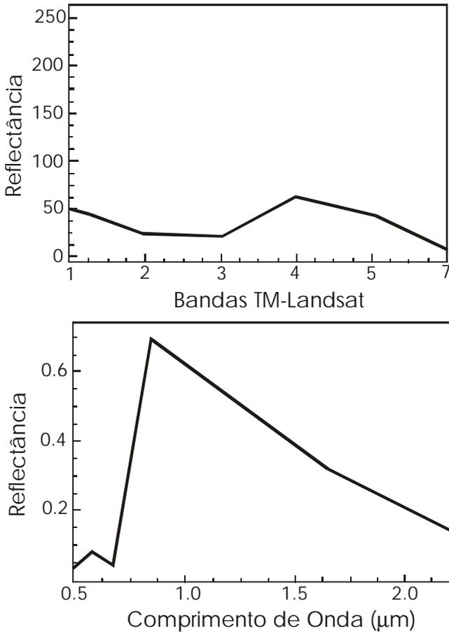
**Figura 2** – Comparação das curvas relativas aos números digitais e os valores de reflectância aparente do topo da atmosfera para um *pixel* de vegetação verde para o sensor TM-Landsat 5.
