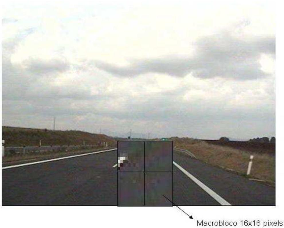
Figura 2.2 : Quadro com macroblocos destacados.
