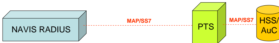
Figura 6.10 – Solução AAA Alcatel-Lucent e conexão ao HLR/AuC
