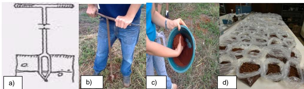
**Figura 7.** a) Representação do Trado holandês, utilizado na coleta das amostras de solo; b) amostragem de solo; c) homogeneização das subamostras para formação de uma amostra composta de solo e d) amostras de solos acondicionadas em sacos plásticos para posterior armazenamento em câmara fria.
