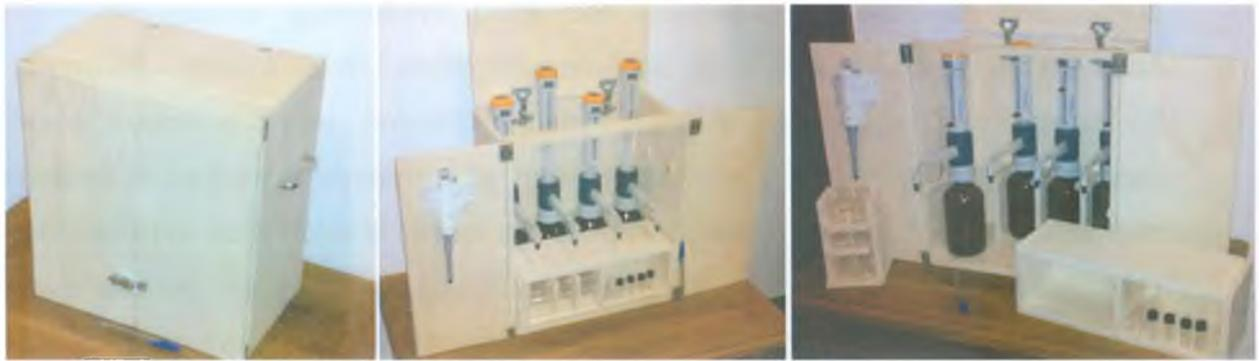
**Figura 40** – Protótipo do Kit para análise colorimétrica de metanol na presença de etanol e aldeídos.
