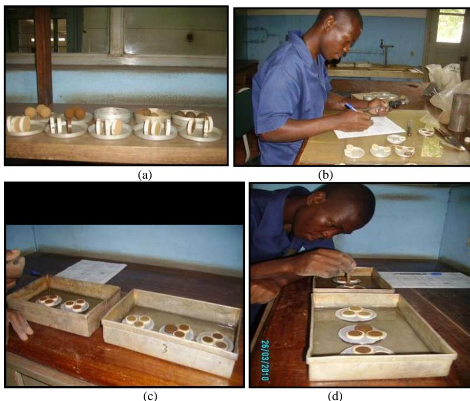
Figura 3. 7: Ilustrando método da Pastilha: (a) secagem das pastilhas; (b) medida da contração; (c) reabsorção d`água e (d) penetração
