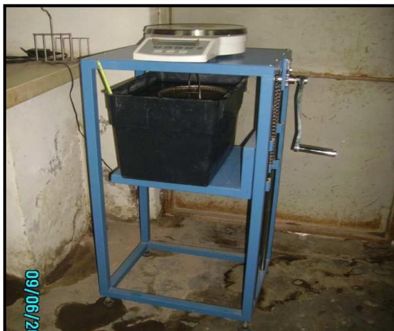
Figura 3. 9: Balança hidrostática usada no ensaio de absorção durante 48 horas
