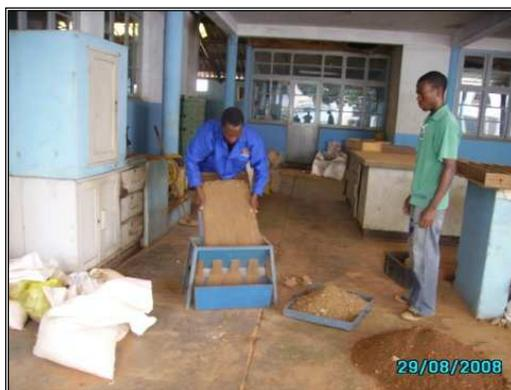
Figura 3. 5: Ilustra a utilização de repartidor para a obtenção da amostras (Sampling method MA2)
