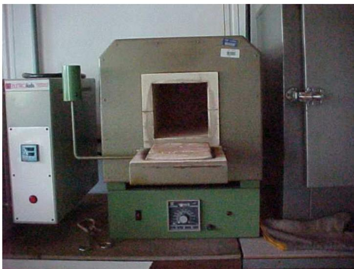
**Figura 3.23** – Mufla utilizada para calcinação das amostras de RSU e lixiviados.
