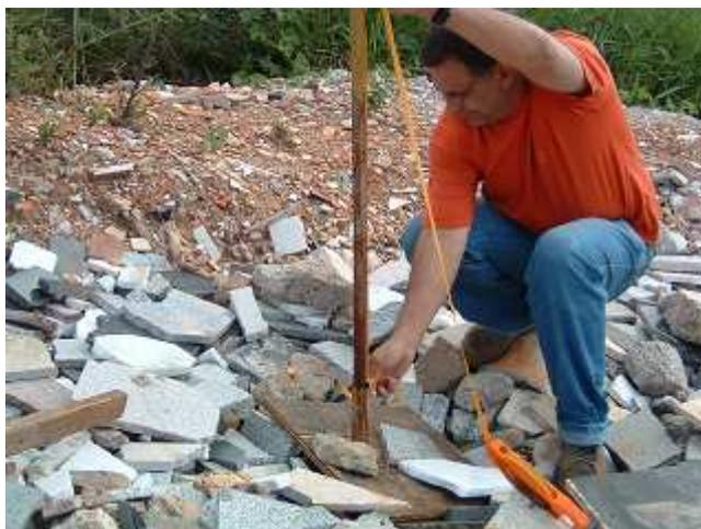
**Figura 3.19-** Medida e leitura do recalque na Célula CEL-01.
