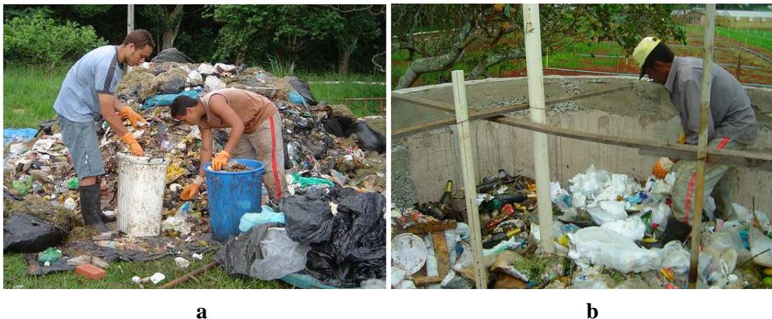
**Figura 3.15** – Disposição do lixo no lisímetro experimental: a) disposição manual do lixo nos lisímetros usando recipientes plásticos; c) espalhamento e homogeneização de lixo antes de cada compactação manual.
