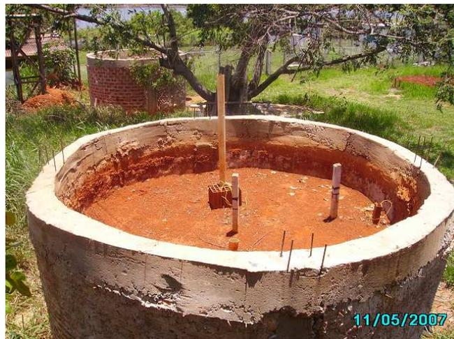
**Figura 3.17-** Vista do lisímetro LS-01 mostrando a camada de cobertura fina.
