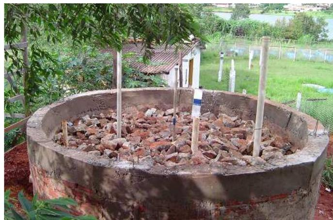
**Figura 3.18-** Vista do lisímetro LS-02 mostrando a camada de cobertura granular.
