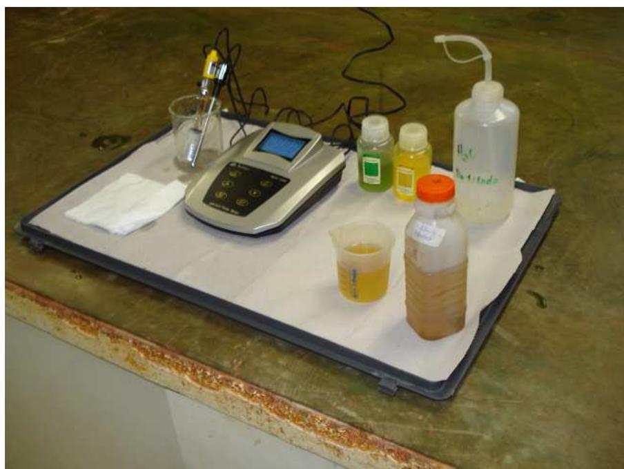
**Figura 3.25** – Aparelho medidor digital Mph-1200, leituras de pH e  $E_H$ .
