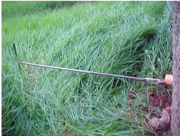
**Figura 3.22** – Processo de amostragem de RSU via tradagem (lisímetro experimental).
