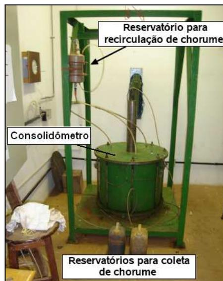
**Figura 2.17** – Consolidômetro de grandes dimensões utilizado nos ensaios de compressão confinada (Nascimento, 2007).
