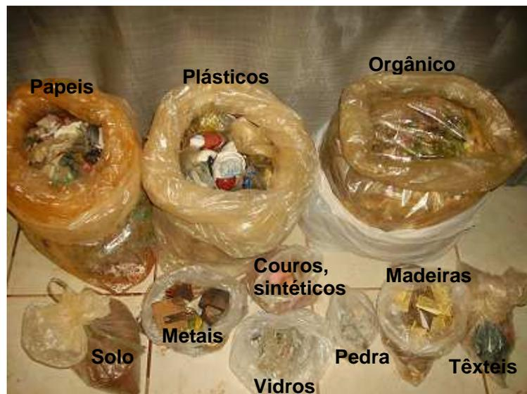
**Figura 3.3** – Proporção gravimétrica dos RSU (5º ensaio de compressão confinada).
