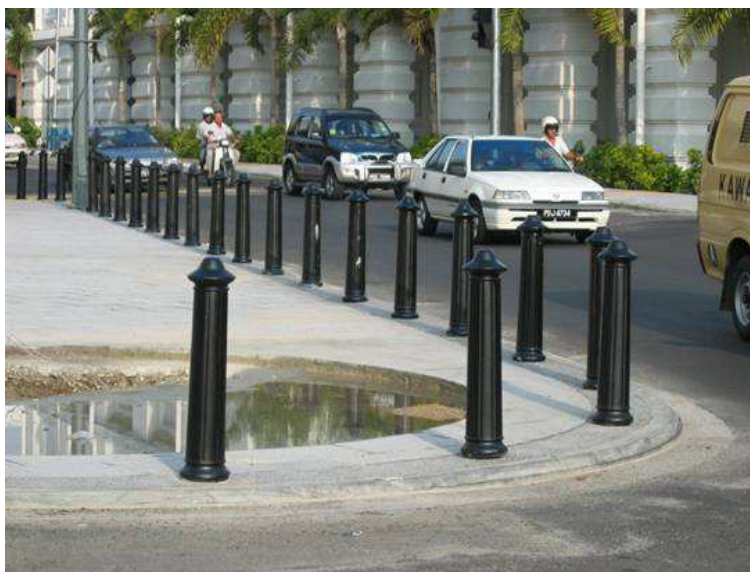
Figura 6.3: Mecanismos de proteção contra impacto veicular.
