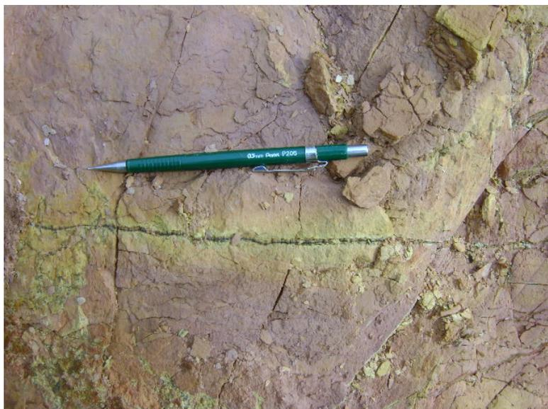
**Figura 5.4** - Fratura com percolação, evidenciada pela tonalidade amarelada ao longo do plano de infiltração da água (em seção).
