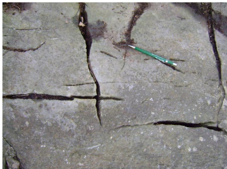
**Figura 5.7** - Fraturas trativas em calcário micrítico com ampliação de abertura devido à dissolução do carbonato (em seção).
