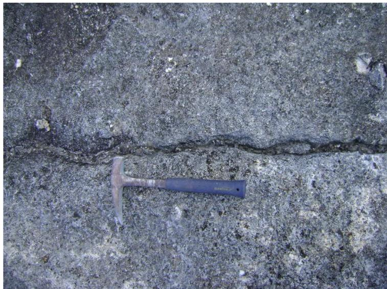
**Figura 4. 9** - Lajedo de brecha carbonática exibindo fratura grande, rugosa e aberta (em planta).
