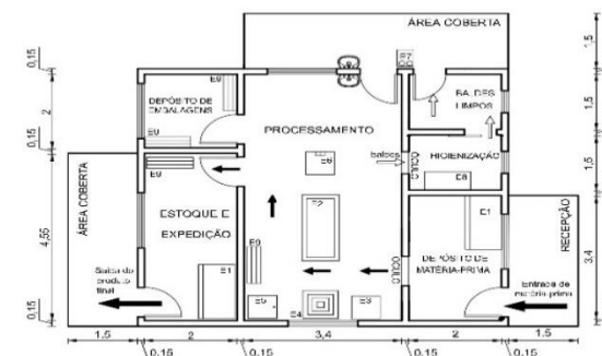
Modelo para recepção de matéria-prima proveniente de unidades de extração (não possui sala de coleta).
