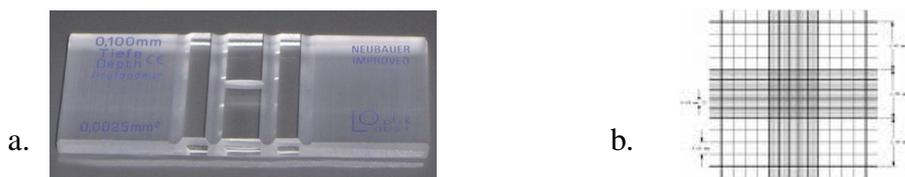
**Figura 23:** Câmara de Neubauer (a) e um quadrante da câmara de Neubauer (b)
