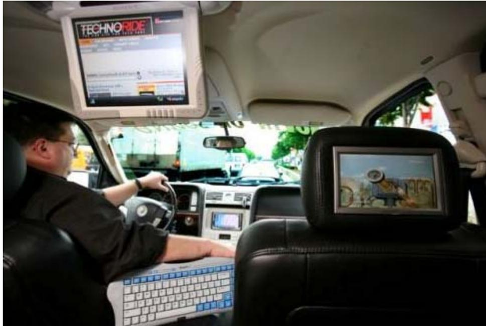
Figura 1.3: Veículo da Chrysler com conexão WiMAX.
