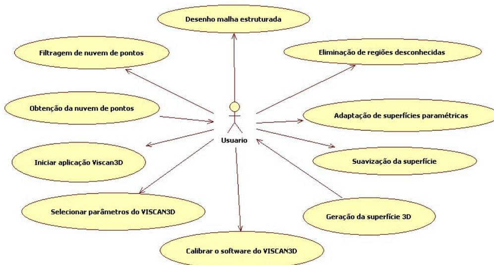
Figura C.9 Diagrama de caso uso do sistema de reconstrução de superfícies
