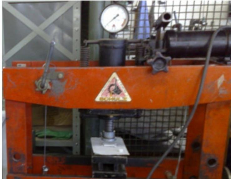
**Figura 3.6** Prensa utilizada no sistema de medição de pressão montado para este trabalho.
