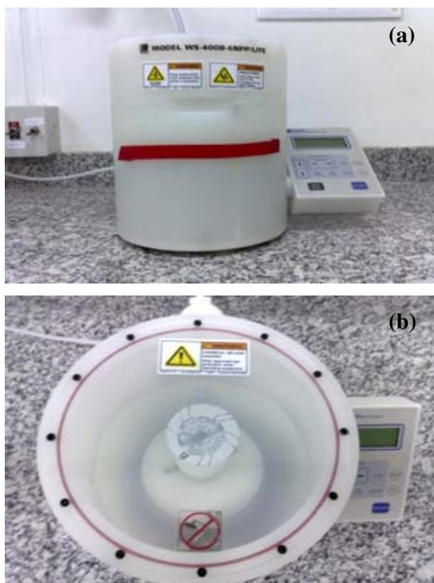
**Figura 3.1** *Spincoater Laurel* modelo *WS-400B-6NPP/LITE*, (a) visão frontal do aparelho e painel de controle; (b) visão superior do compartimento porta amostras.
