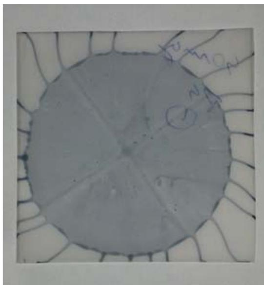
**Figura 4.5** Amostra obtida pelo *spincoater* nas condições de 10 segundos a 500 rpm e 25 segundos a 1000 rpm.
