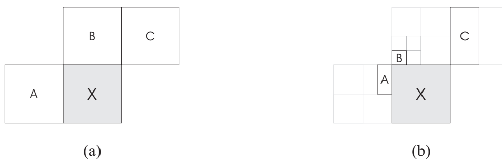
Figura 2.7: Predição do Vetor de Movimento: (a) Modelo geral; (b) Exemplo.
