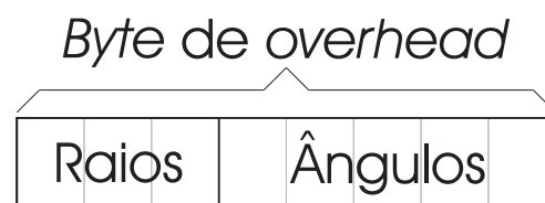
Figura 4.4: Byte de overhead com bits de raios e ângulos.
