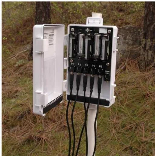
Figura 4. 7 - *Datalogger* modelo EM50 para armazenamento de dados digitais e analógicos. Fonte: Decagon Devices.
