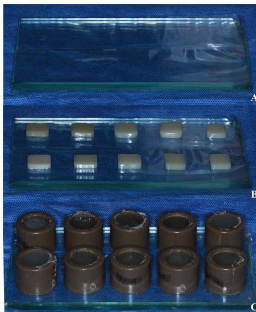
Figura 2- Inclusão das cerâmicas em resina acrílica nos tubos PVC. (A) isolamento da placa de vidro com fita adesiva. (B) posicionamento das cerâmicas na placa e posterior posicionamento dos tubos de PVC circunscrevendo-as. (C) inserção da resina acrílica e espera do tempo de presa.
