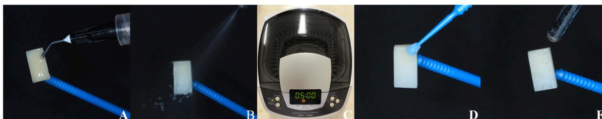
Figura 17 - Protocolo CT+S para EDX. (A) condicionamento com HF 5% pelo tempo indicado pelo fabricante. (B) spray ar-água por 15s. (C) banho ultrassônico em água destilada por 5min. (D) aplicação do silano, aguardar 1min. (E) jato de ar por 10s.
