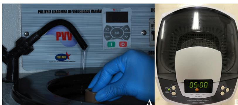
Figura 3 - Polimento dos blocos. (A) polimento do bloco na politriz. (B) banho ultrassônico em água destilada por 5min.
