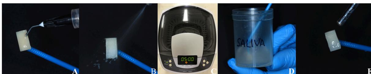
Figura 16 - Protocolo NEG para EDX. (A) condicionamento com HF 5% pelo tempo indicado pelo fabricante. (B) spray ar-água por 15s. (C) banho ultrassônico em água destilada por 5min. (D) imersão na saliva por 1min. (E) secagem com jato de ar por 10s.
