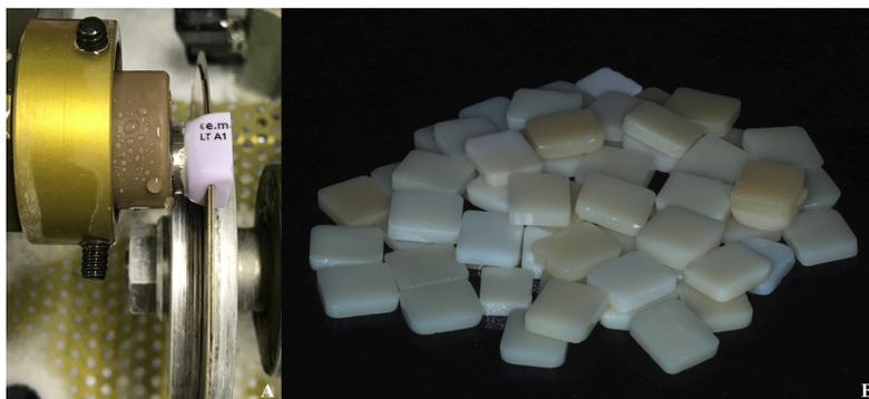
Figura 1 - Corte das cerâmicas. (A) cerâmica seccionada na cortadeira. (B) fatias de cerâmica após cristalização em forno especial.
