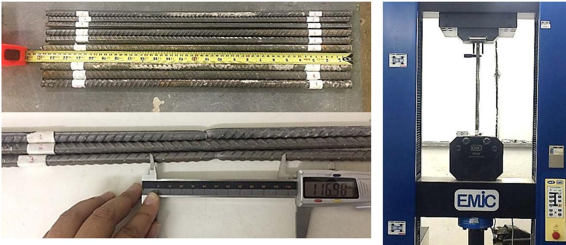
Figura 3.35– Ensaio realizado nos corpos de prova de aço
