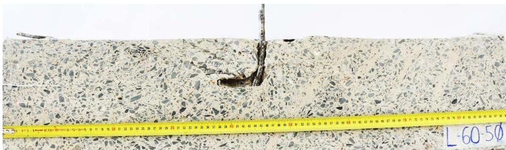
Figura 4.39 – Desdobramento da barra com dobra com 90° - Modelo L-60-5Ø (2)
