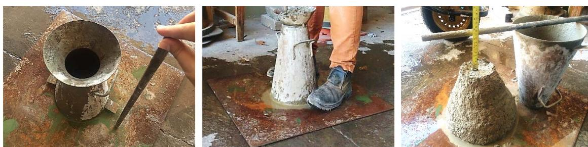
Figura 3.31 -Teste de abatimento do tronco de cone
