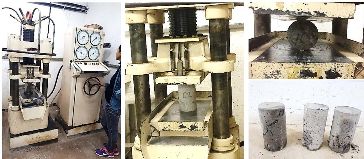
Figura 3.33–Ensaio de resistência à tração e compressão do concreto
