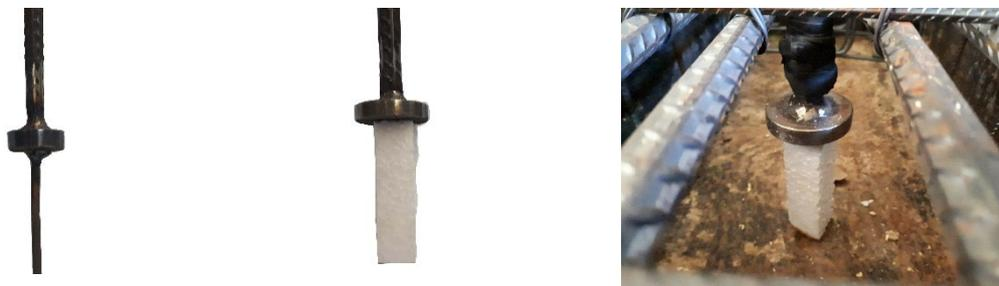
Figura 3.37 – Detalhe construtivo auxiliar para a medição de deslocamento do LVDT 1.
