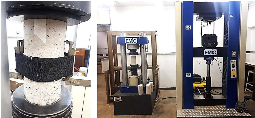
Figura 3.34—Ensaio de módulo de elasticidade do concreto
