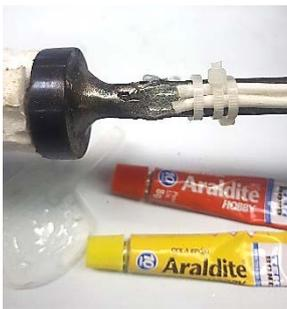
f) Proteção mecânica com resina epóxi
