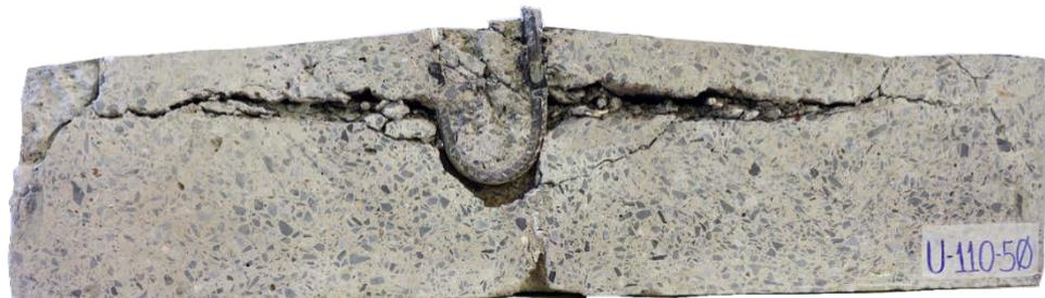
Figura 4.17 – Superfície de ruptura dos modelos de ganchos com 180°
