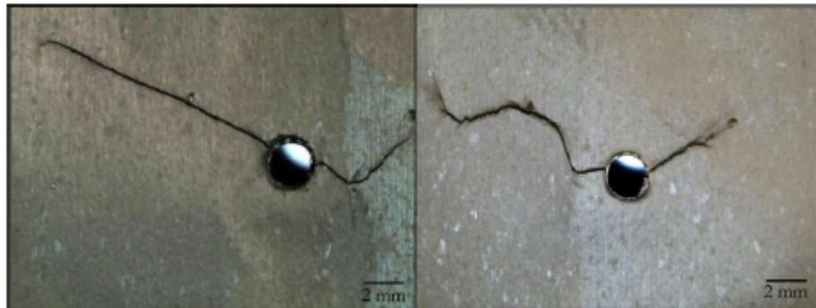
Figura 2.1 – Exemplo de propagação de uma trinca que nasceu na raiz de um furo. (Lorenzino e Navarro, 2014).
