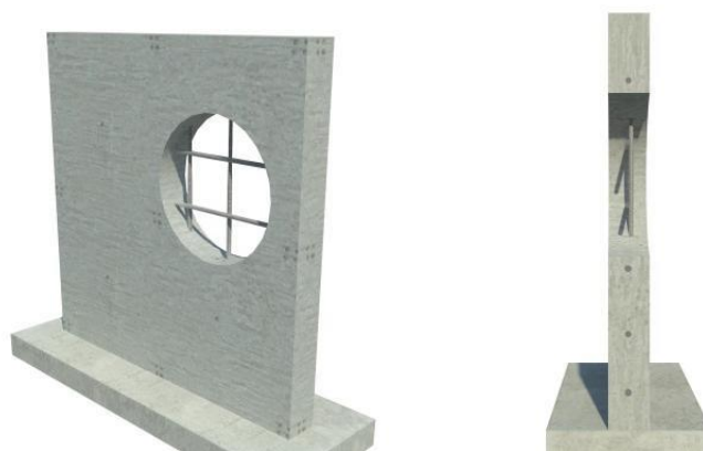
Figura 7: Detalhe e corte da vedação em parede de concreto.
