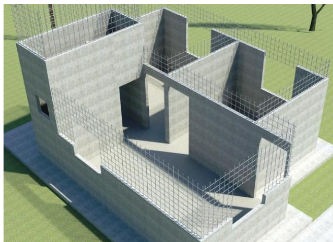
Figura 4: Esquema de inserção de armaduras.
