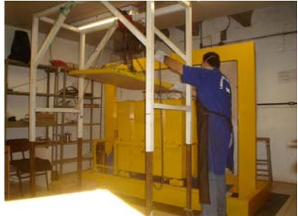
Figura 4.7 – Posicionamento da tampa de transmissão de esforços normais
