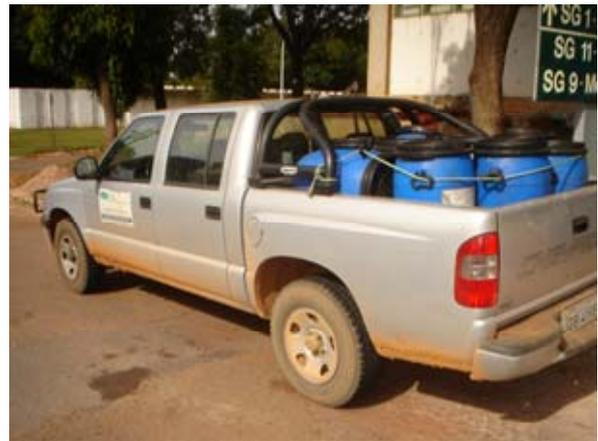
Figura 4.4 – Tonéis plásticos para acondicionamento e transporte das amostras
