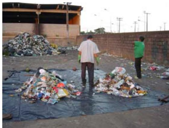
Figura 4.3 – Triagem dimensional das amostras
