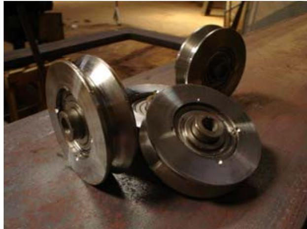
Figura 3.6 – Detalhes das roldanas ( 3” )
