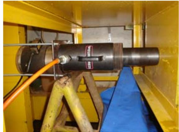
Figura 3.15 – Detalhes da célula de carga para a determinação de esforços cisalhantes
