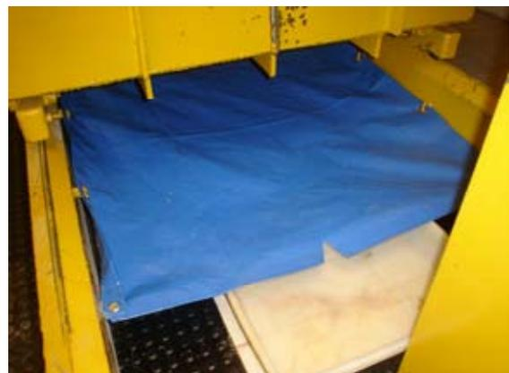
Figura 3.13 – Sistema de coleta e condução de chorume
