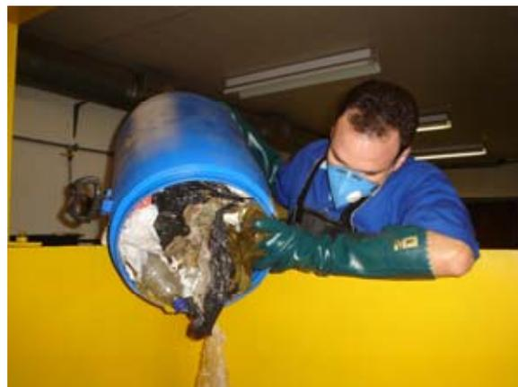
Figura 4.6 – Lançamento do RSU na célula de cisalhamento
