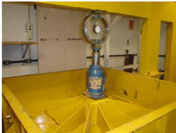
Figura 3.14 – Aplicação e medição de esforços normais
