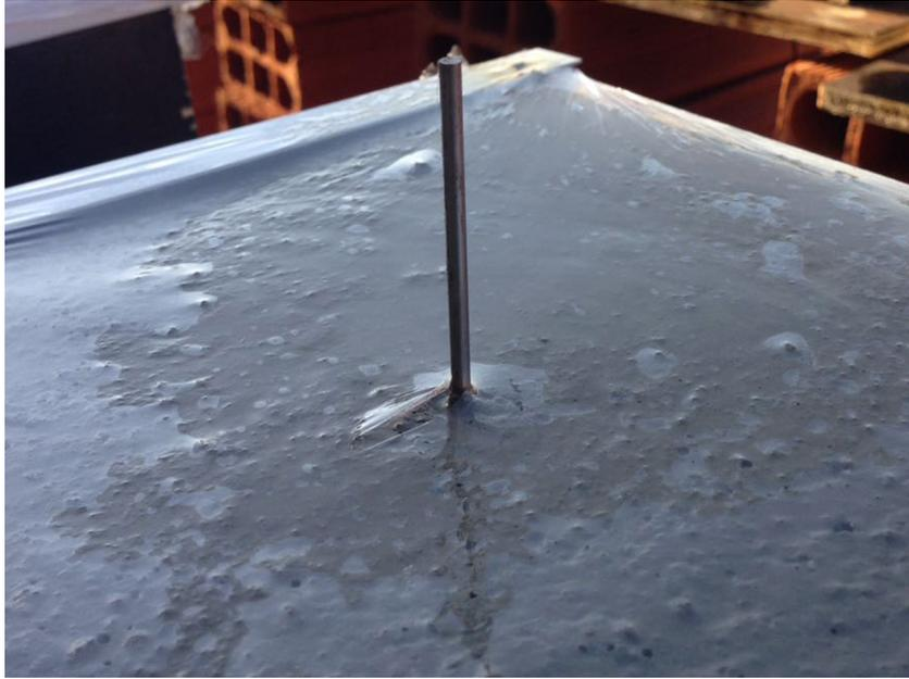
**Figura 3.8** – Detalhe do plástico filme para cura selada.
