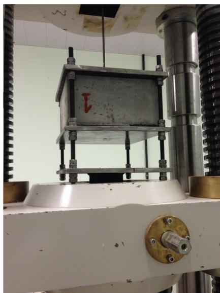
**Figura 3.15** – Corpo de prova na garra para início dos ensaios de arrancamento.
