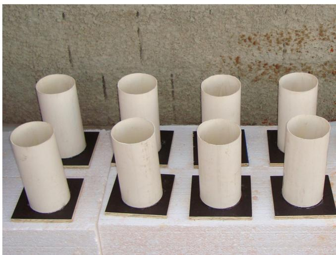
**Figura 3.2** – Molde para corpos de prova de 100mm x 200mm.
