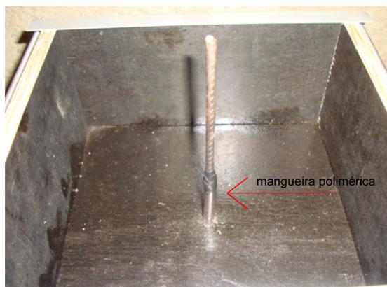
**Figura 3.5** – Detalhe da mangueira na parte inferior da barra.
