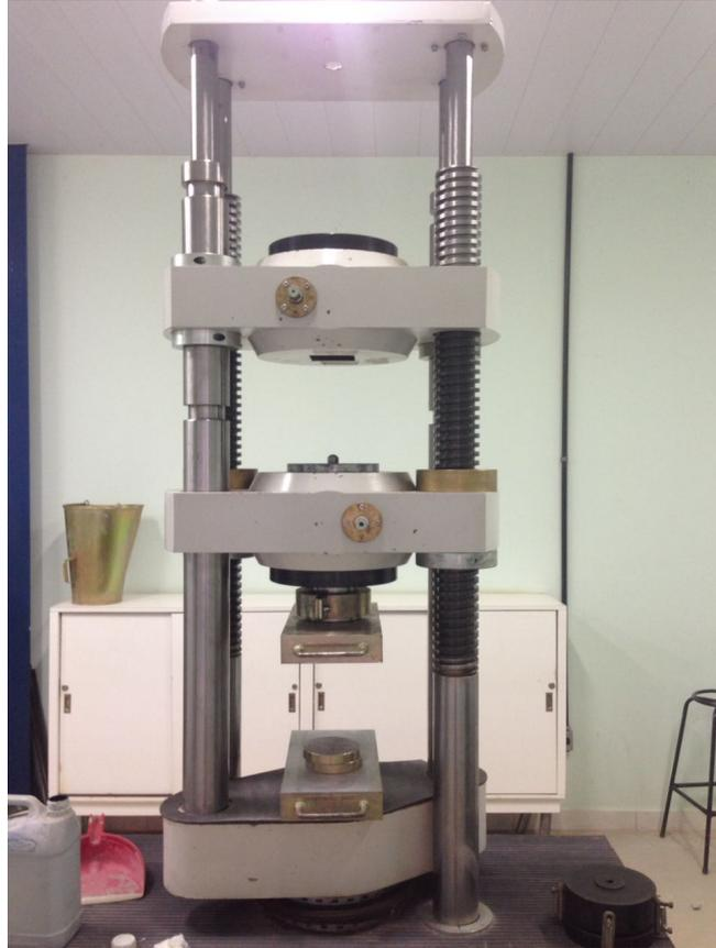
**Figura 3.12** – Máquina Universal de Ensaiois CONTENCO®.
