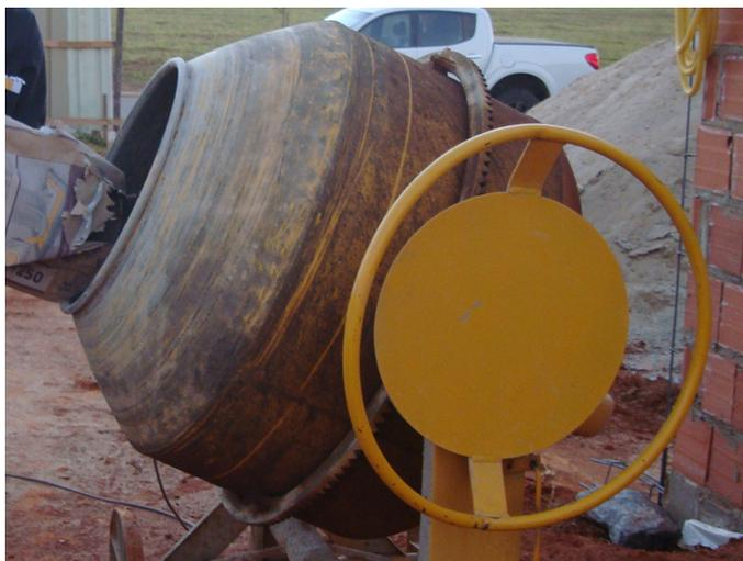
**Figura 3.1** – Betoneira utilizada para misturar a massa.
