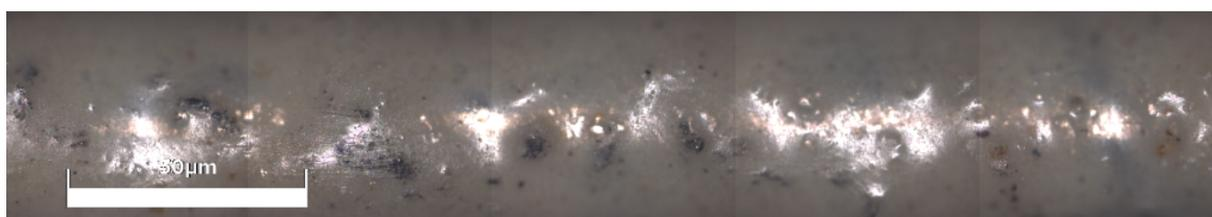
**Figura 3.11** – Fotografia do CONFOCAL da barra de NiTi com adesivo estrutural epóxi.
