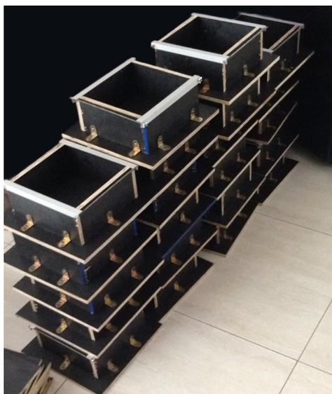
**Figura 3.4** – Fôrmas para moldagem dos Corpos de Prova.
