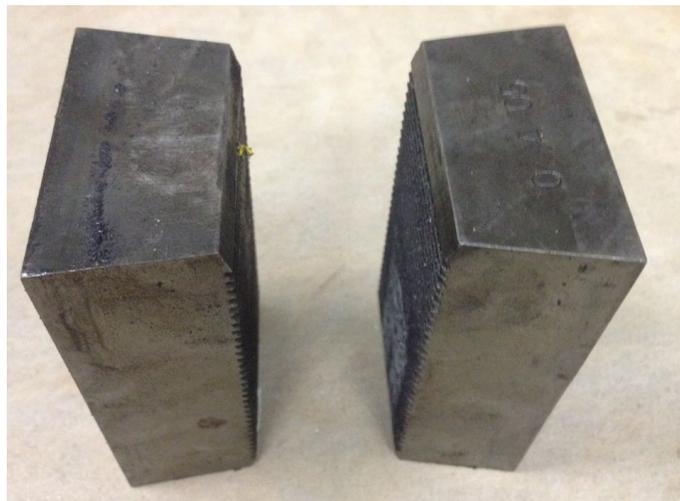
**Figura 3.13** – Castanhas da Máquina Universal de Ensaiois aproximadamente 20 centímetros de altura.
