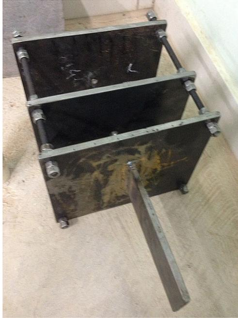
**Figura 3.14** – Garra adaptada para ensaio de tração.
