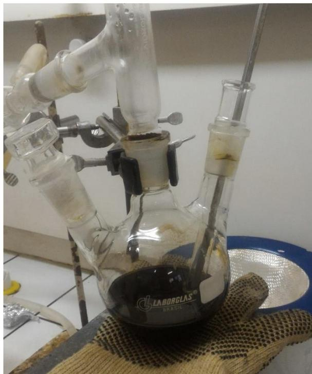
**Figura 15** - Resíduo do craqueamento térmico
