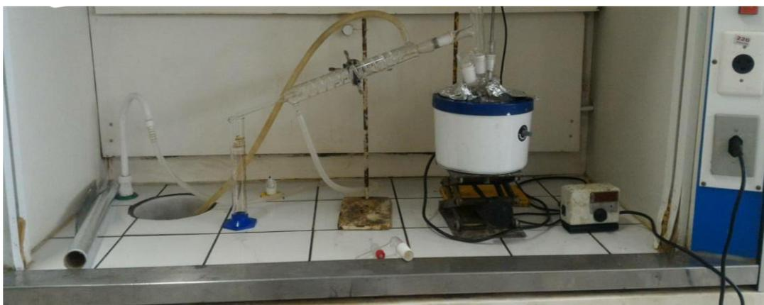
**Figura 14** - Sistema utilizado para a reação de pirólise
