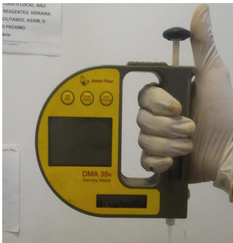
**Figura 18** - Densímetro digital (DMA 35N)
