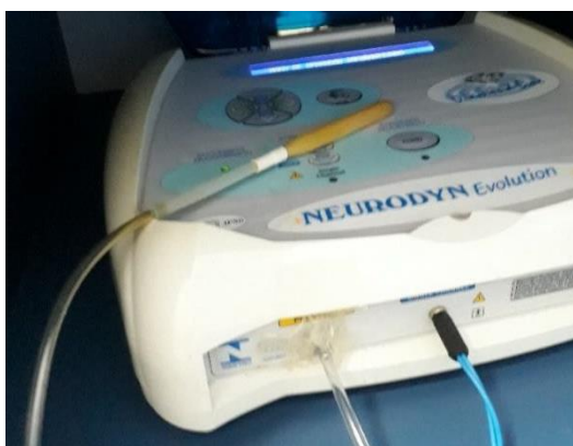
Figura 1.4 Aparelho de biofeedback com a sonda de mensurar a pressão intraanal acoplada (Neurodyn Evolution – Ibramed, Brasil).
