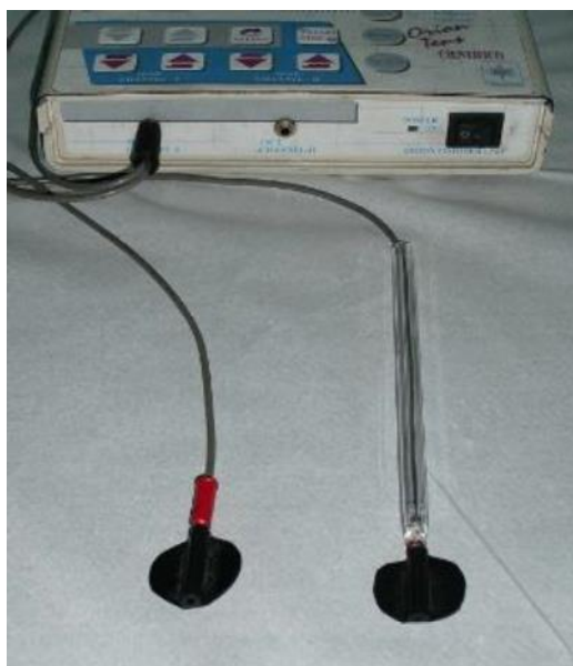
Figura 1.8 Fotografia do protótipo inicial do eletrodo móvel utilizado no protocolo experimental desta pesquisa.
