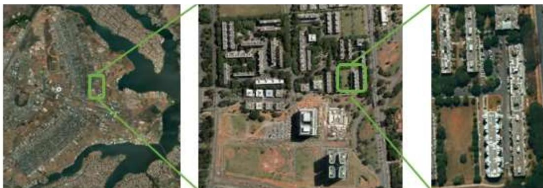
Criou-se um modelo tridimensional correspondente ao local selecionado com proporção da grade para os três eixos (x, y e z) de 2,5 m x 2,5 m x 3 m. O tamanho real da área é 35.200,00 m<sup>2</sup> (220 m x 160 m), equivalente ao modelo de 88x64x30 (X, Y, Z). Para as áreas de borda foi reservado um espaço equivalente a 5 grades.
