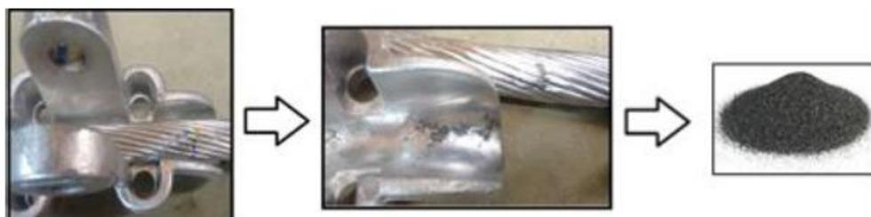
**Figura 2.6. Óxido de alumínio acumulado na superfície do grampo.**
