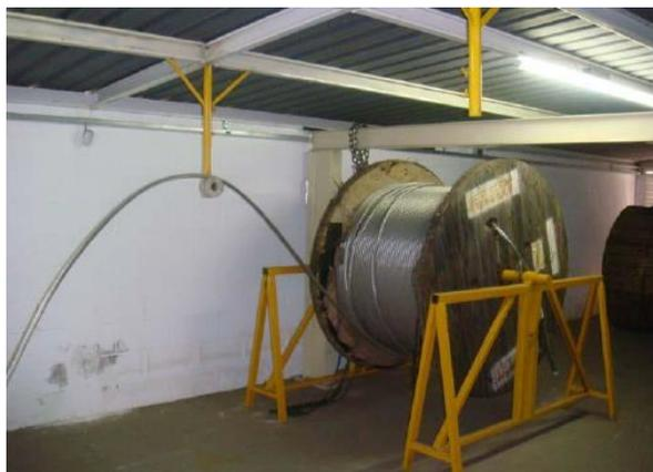
**Figura 4.13. Bobina do condutor CAL 1055 MCM.**
