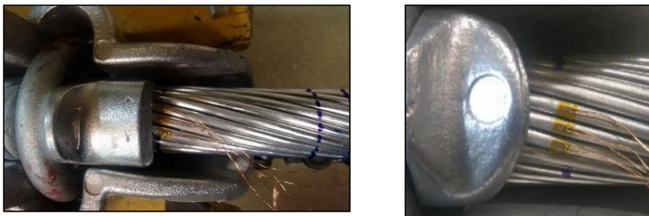
**Figura 4.19. Extensômetros colados nos três fios mais altos e opostos ao UPC.**
