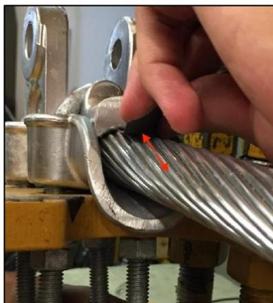
**Figura 4.30. Processo de lixamento da superfície do fio.**
