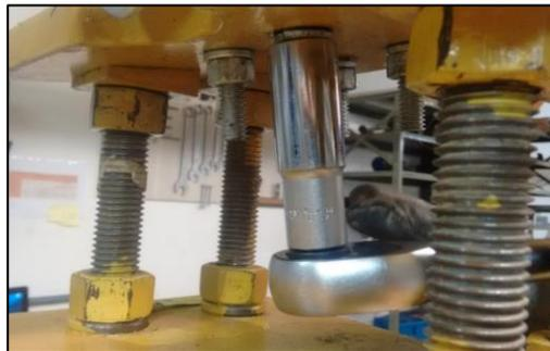
**Figura 4.18. Fixação do grampo de suspensão e aplicação do torque nas porcas.**
