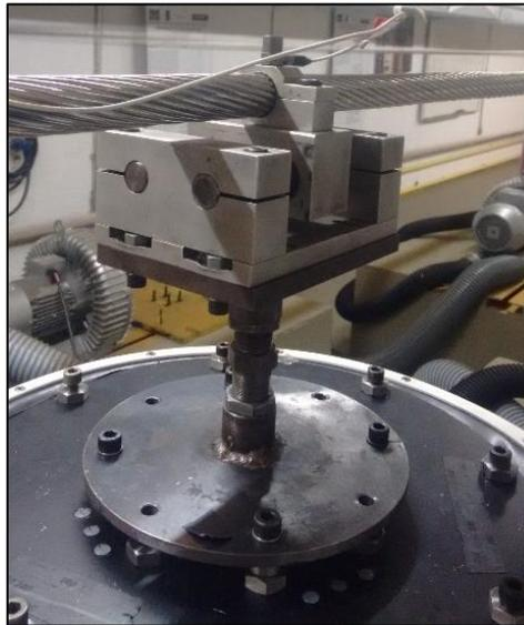
**Figura 4.22. Dispositivo de alinhamento do *shaker* e abraçadeira com acelerômetro.**
