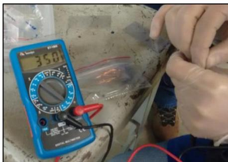
**Figura 4.38. Verificação da resistência dos extensômetros.**
