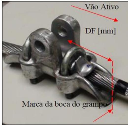
Figura 4.26. Medida da distância da falha (DF), da boca do grampo até a quebra.
