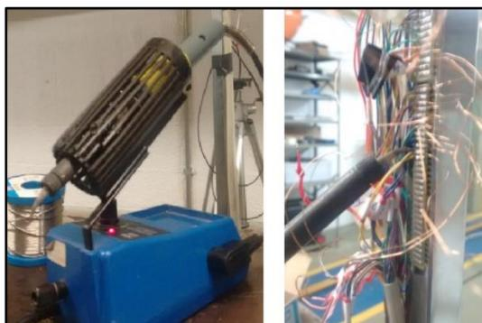
**Figura 4.41. Soldagem dos fios dos extensômetros no cabo de extensão com ADS.**
