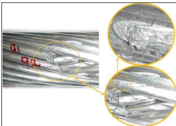
**Figura 5.22. Fios rompidos devido o desgaste fio-grampo na camada externa da amostra.**
