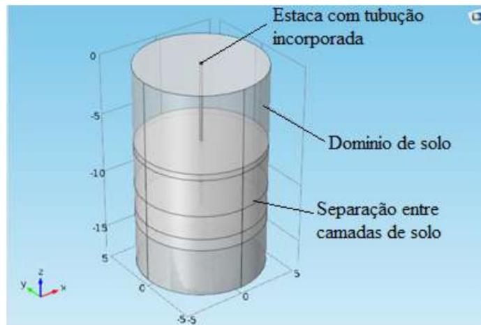
**Figura 2.25.** Esquema de modelagem de uma estaca de energia. (Orozco, 2016)
