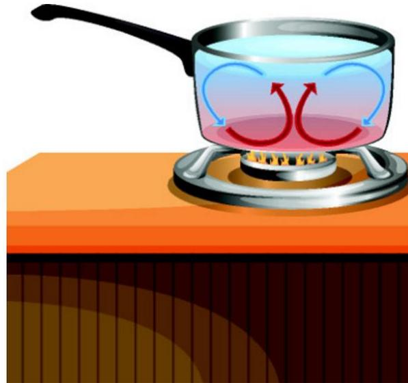
**Figura 2.9.** Água sob processo de convecção sendo aquecida em uma panela. (Teixeira, 2013)
