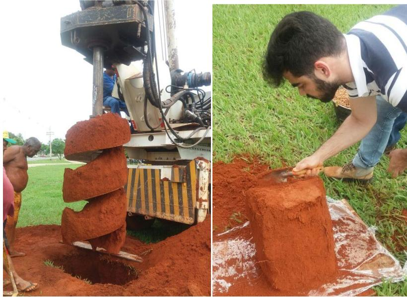
**Figura 3.13.** (a) Escavação mecanizada do poço; (b) Preparação da amostra indeformada.
