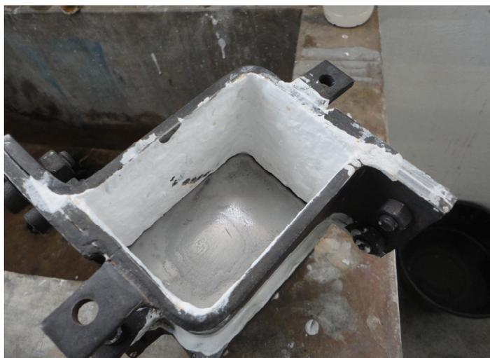
**Figura 3.3:** Lingoteira após aplicação de cimento a base fibra cerâmica sílico-aluminosa.
