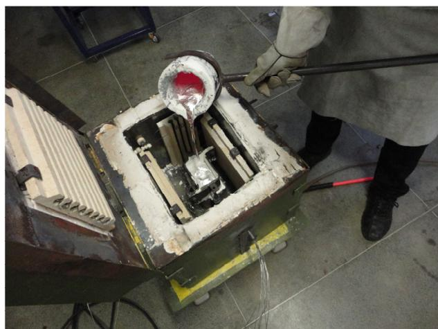
**Figura 3.5:** Vertendo o metal líquido dentro da lingoteira.
