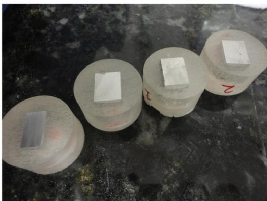
**Figura 3.7:**Corpos de análise já embutidos com resina acrílica.
