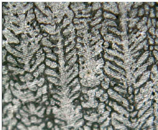
**Figura 1.1:** Morfologia dendrítica na interface de crescimento na solidificação da liga Al0,8%Nb.
