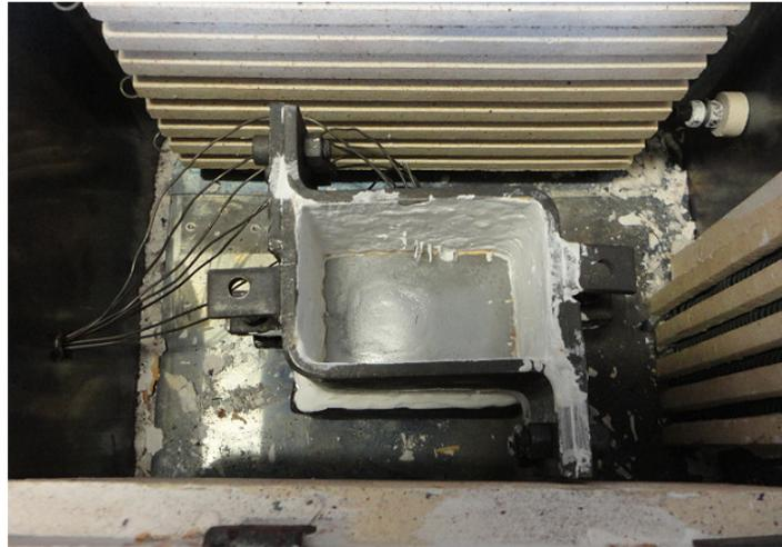
**Figura 3.4:** Posicionamento dos termopares no interior da lingoteira.
