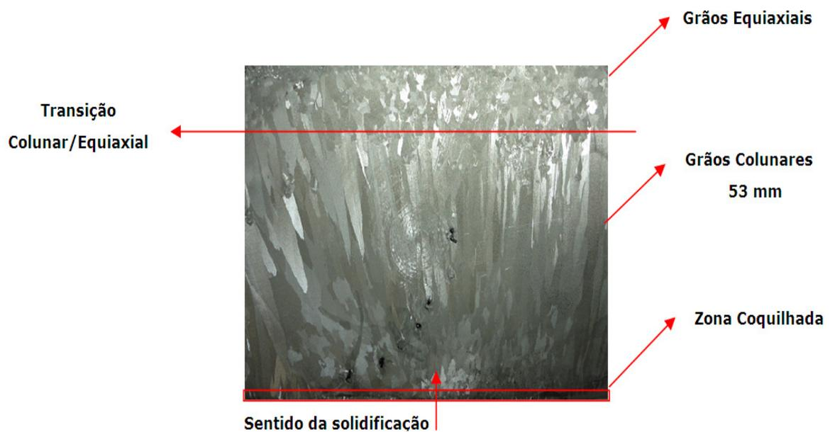
**Figura 2.8:** Representação esquemática de macroestrutura de solidificação observada após o ataque químico de uma liga deste presente trabalho.
