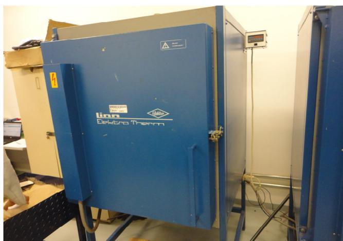
**Figura 3.2:** Forno tipo mufla, fabricante Elektro Therm.
