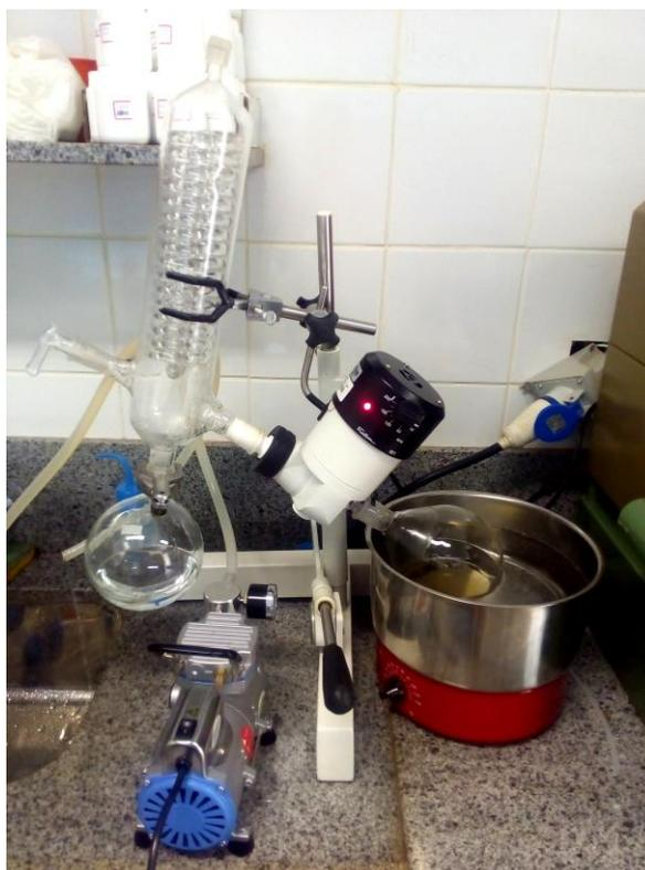
**Figura 34** – Recuperação de etanol por destilação fracionada.
