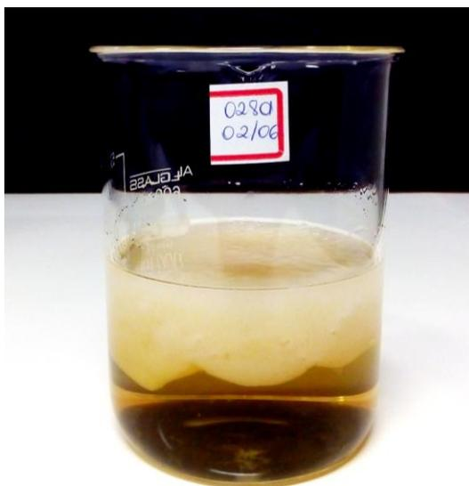
**Figura 8** – Etapa de precipitação da hemicelulose em solução de etanol e ácido acético (1/10<sub>v/v</sub>).
