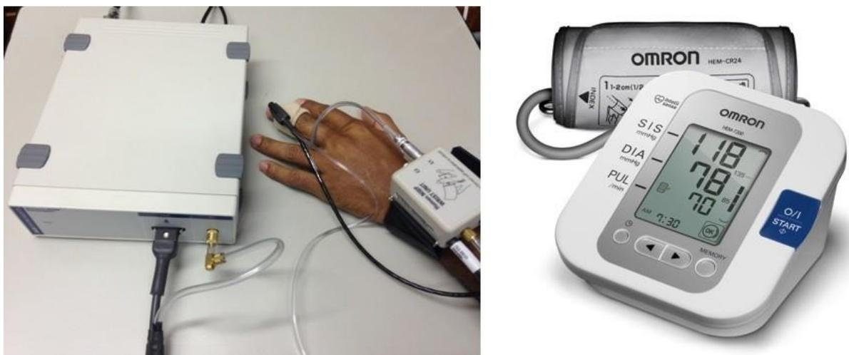
FIGURA 7 – Aparelho de fotopletismografia e esfigmomanômetro automático.
