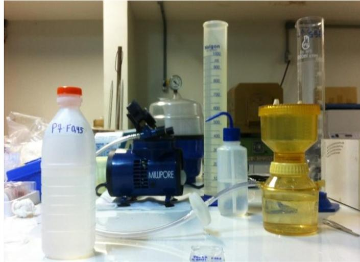
Figura 10: sistema de filtragem de amostras de campo.
