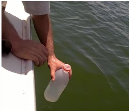
Figura 09: Coleta e condicionamento de amostra de água.
