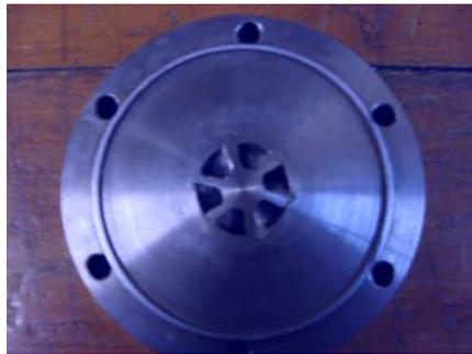
Figura 3.31 - *Swirler* colocado no orifício do flange da pré-câmara.
