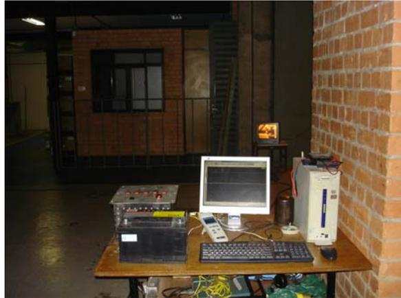
Figura 3.7 - Mesa de controle composta pelo sistema de aquisição, caixa de controle de válvulas e bateria para se promover a ignição.
