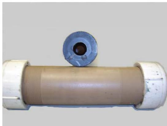
Figura 3.13 - Case de PVC e grão combustível de parafina do motor HP-1 após a centrifugação.
