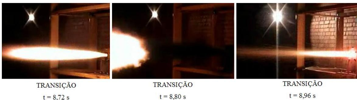
Figura 3.22 - Transição entre a queima da parafina e do PVC. Ao observar as imagens e o passo de tempo, nota-se que a transição é bem definida.
