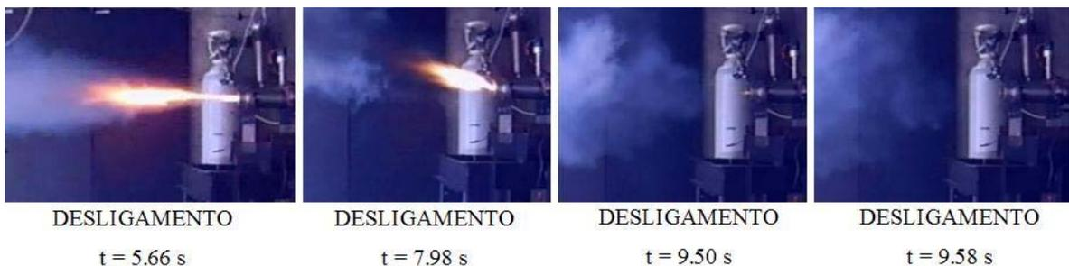
Figura 3.19 - Transiente de desligamento: o evento se define entre o momento de fechamento das válvulas principais e o completo desligamento do motor. Devido à baixa vazão mássica de oxidante a taxa de regressão durante esse período começa a ser negligenciada.
