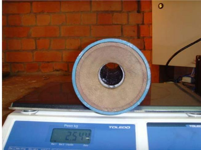
Figura 3.14 - Grão combustível do motor HP-3/SD2; a pós-câmara de mistura de *Celeron* melhora o desempenho do motor e ajuda a proteger termicamente a tubeira do foguete.
