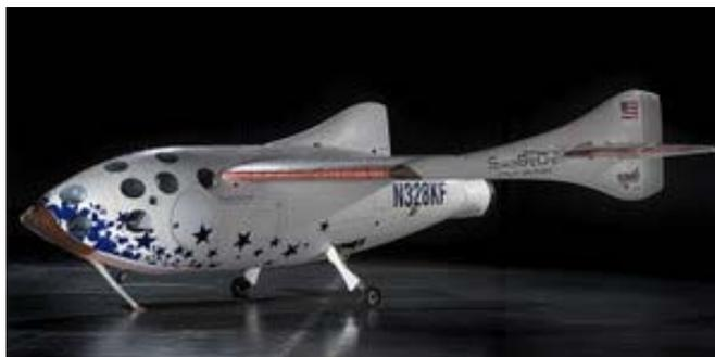
Figura 1.2 - A Nave espacial *Space Ship One* é movida por um foguete híbrido utilizando  $N_2O$  – HTPB.
