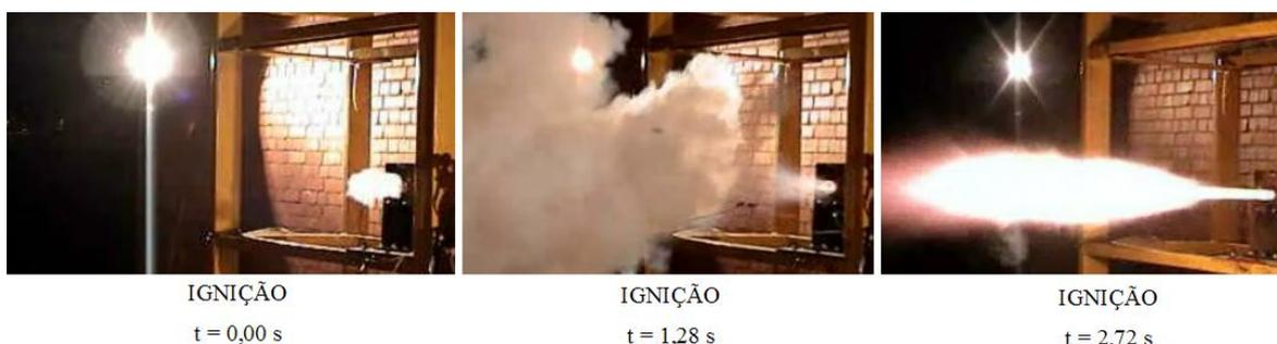
Figura 3.21 - Sequência de ignição: teste com o propulsor HP-3/SD2. O tempo de ignição nesse ensaio foi de 2,72 segundos.
