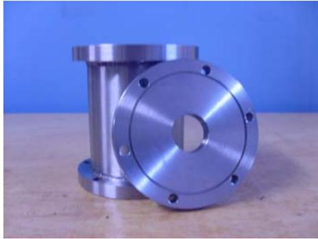
Figura 3.30 - Pré-câmara de mistura e orifício do flange.
