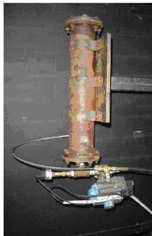
Figura 3.2 - Propulsor HP-1 – Híbrido a base de parafina nº1. No detalhe pode-se observar a válvula de controle do sistema de injeção de oxidante.
