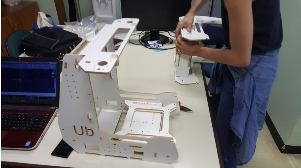
Figura 39 - Protótipo do Modelo 2.2 em MDF branco e montagem efetuado por uma única pessoa
