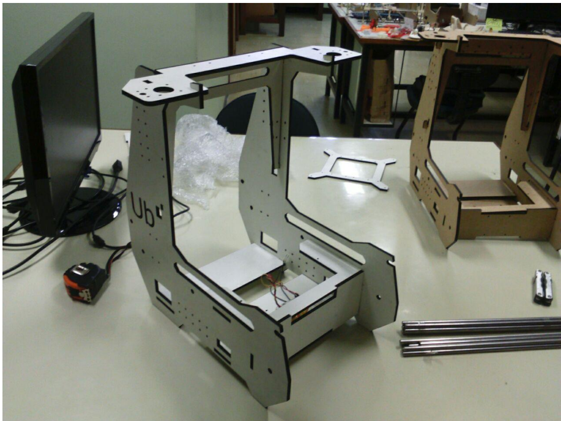
Figura 41 - Protótipo da estrutura do Modelo 2.3 em MDF branco executada com corte a laser
