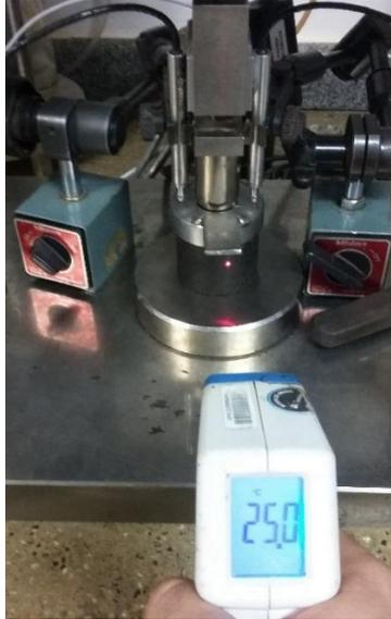
**Figura 3.8.** Ensaio de fluência estática na temperatura 25°C em andamento.
