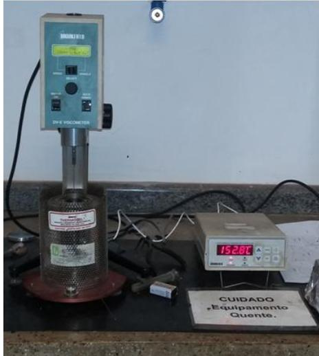
**Figura 3.3.** Viscosímetro Brookfield DV-E modelo RVDVEA115.
