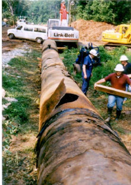
Figura 2.13. Ruptura da tubulação e vazamento de óleo no rio Reedy, Fork Shoals, South Caroline (modificado - National Transportation Safety Board, 1998).
