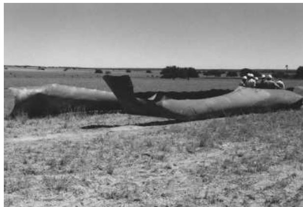
Figura 2.8. Ruptura de tubulação de aço de 75 cm de diâmetro (modificado – Manfredi & Otegui, 2002).
