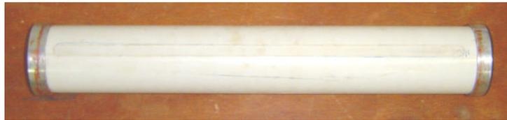
Figura 3.12. Modelo físico da tubulação de explosão.
