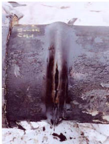
Figura 2.10. Ruptura por dobra em tubulação, Near Chalk Point, Maryland (modificado - National Transportation Safety Board, 2000e).
