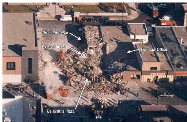
Figura 2.3. Vista geral pós-explosão em decorrência de vazamento de tubulação de gás com  $\frac{3}{4}$ " de diâmetro (modificado - National Transportation Safety Board, 2000a).
