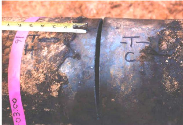
Figura 2.9. Ruptura de uma tubulação de combustível diesel, Knoxville, Tennessee (modificado - National Transportation Safety Board, 2000c).
