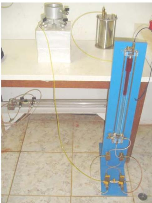
Figura 3.13 – Preenchimento das conexões da célula-base e do medidor de variação de volume com água deaerada
