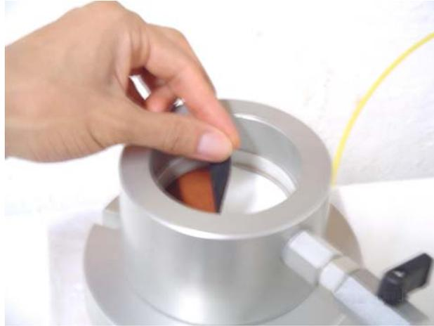
Figura 3.16 – Disco de borracha para evitar impregnação da amostra
