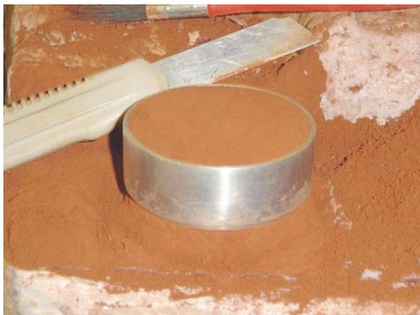
Figura 3.9 – Moldagem dos corpos de prova
