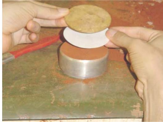
Figura 3.11 – Posicionamento do papel filtro e pedra porosa inferior sobre a superfície inferior da amostra.
