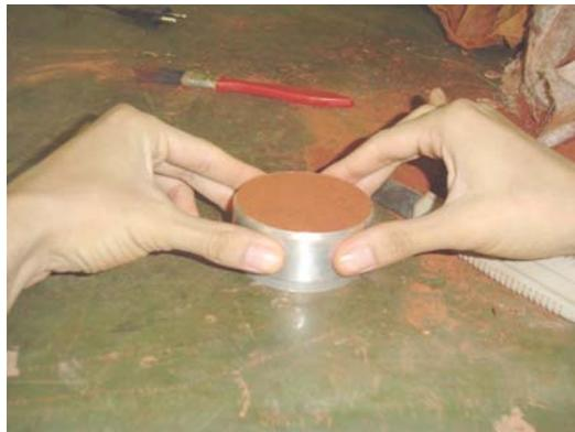
Figura 3.10 – Disco rígido posicionado dentro do anel de moldagem com o corpo de prova
