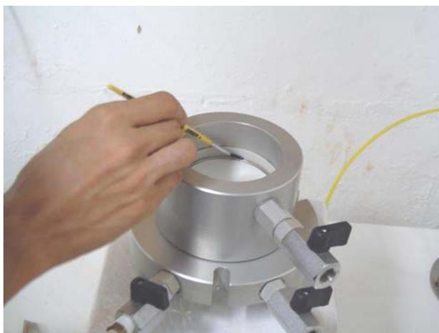
Figura 3.15 – Vedação do espaço entre o anel e a parede da célula-corpo
