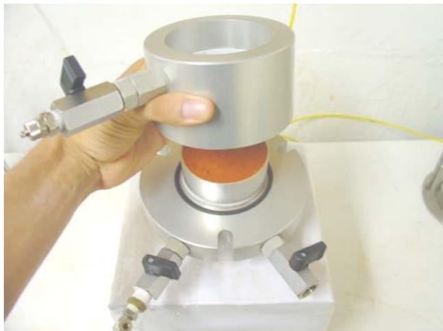
Figura 3.14 – Posicionamento da célula-corpo
