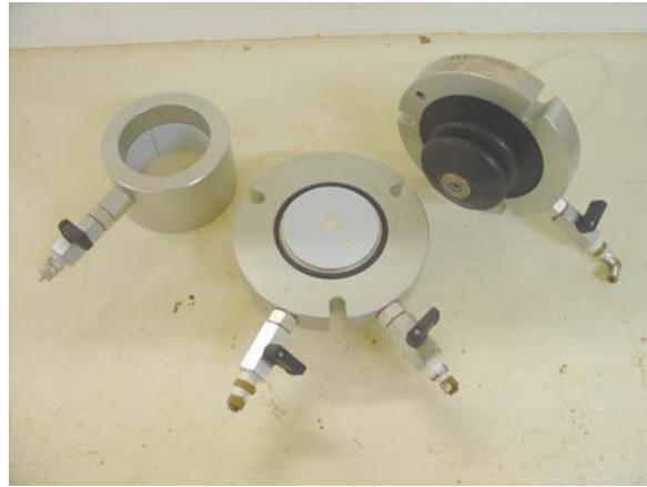
Figura 3.4 – Partes componentes da célula Rowe
