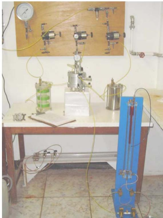
Figura 3.7 – Célula Rowe e equipamento complementar
