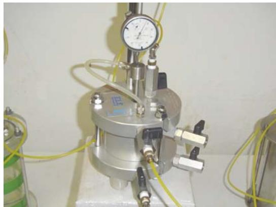
Figura 3.20 – Célula montada com extensômetro medidor de recalques
