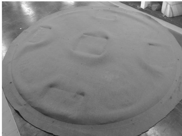
Figura 6.1. Amostra do elemento de reforço GTX-C (pós-ensaio).
