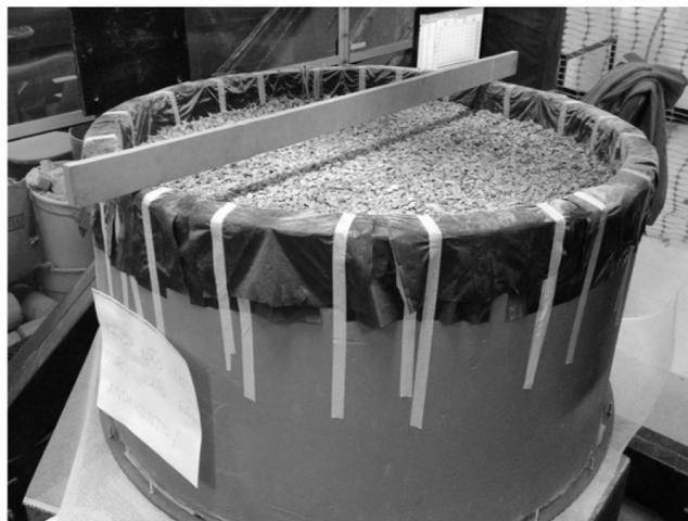
Figura 3.13. Régua usada para medir os recalques da superfície dos aterros granulares.
