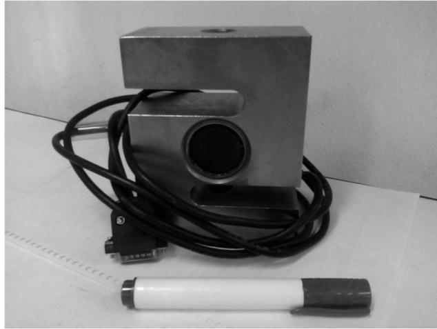
Figura 3.16. Célula de carga utilizada nos ensaios.
