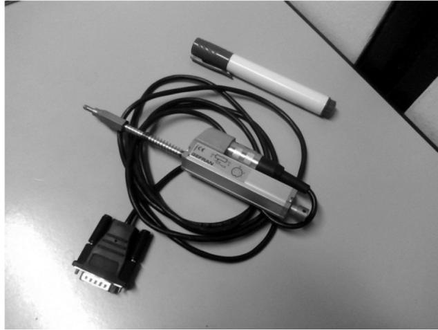
Figura 3.14. LVDT utilizado nos ensaios.
