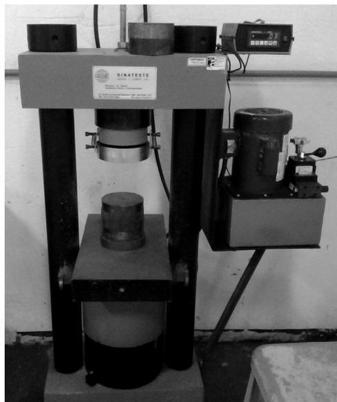
Figura 3.17. Prensa *Dinateste* empregada para a calibração da célula de carga.
