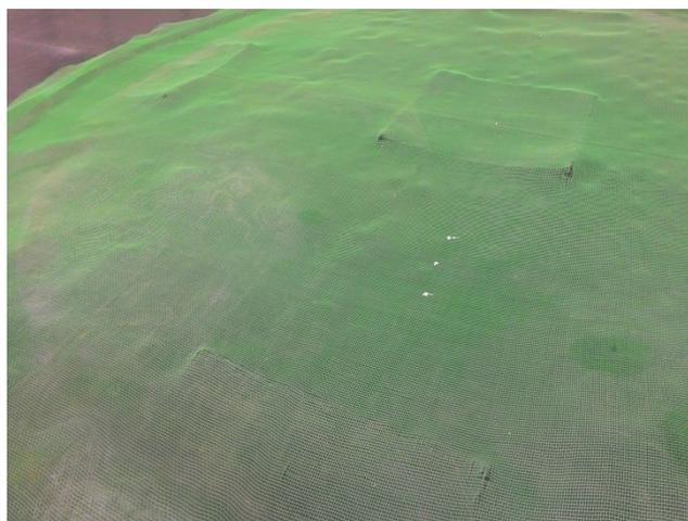
Figura 6.2. Amostra do elemento de reforço GTX-2 (pós-ensaio).
