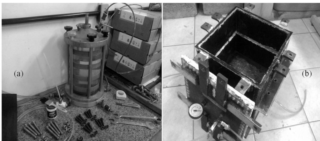
Figura 3.19. Conjunto de elementos empregados para a calibração das células de tensão total. (a) interface ar comprimido-água e (b) caixa rígida utilizada para a calibração das CTTs.
