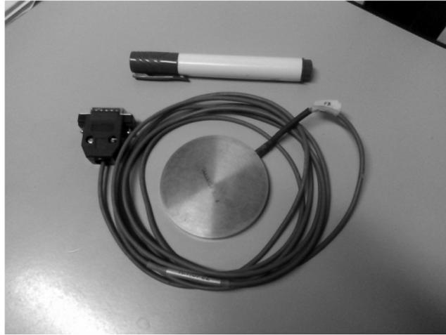
Figura 3.18. Células de tensão total utilizadas nos ensaios.
