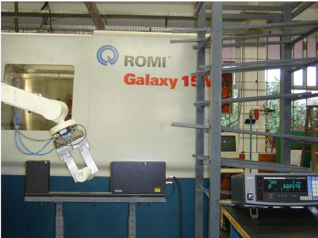
Figura 7.12 - Robô posicionando a peça na unidade de medição do micrômetro.
