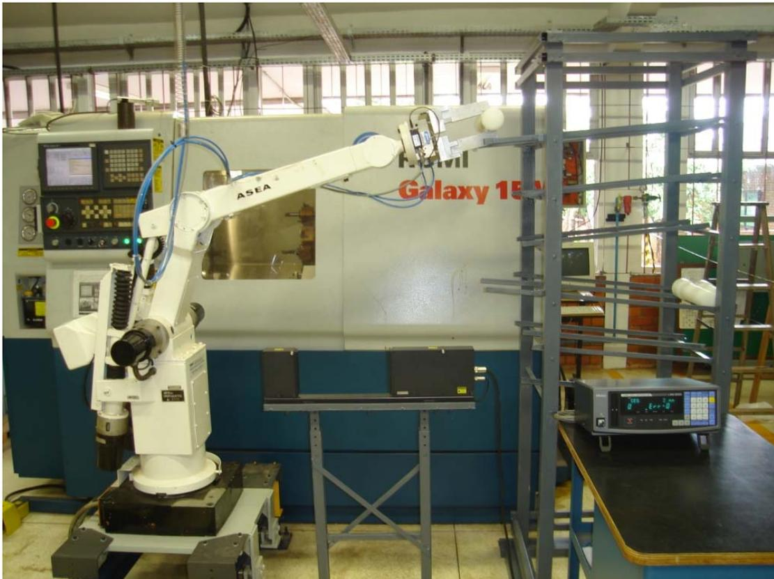
Figura 7.9 - Robô retirando o tarugo do *pallet*.
