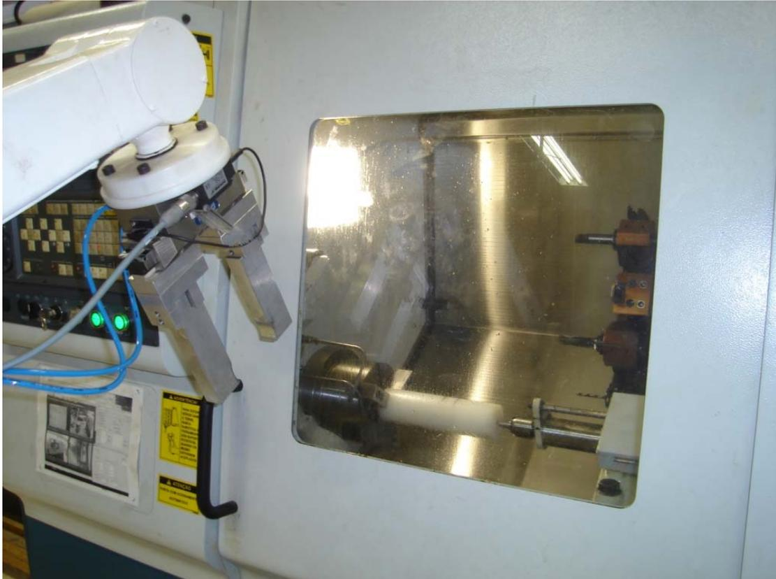
Figura 7.11 - Robô aguardando a usinagem da peça.
