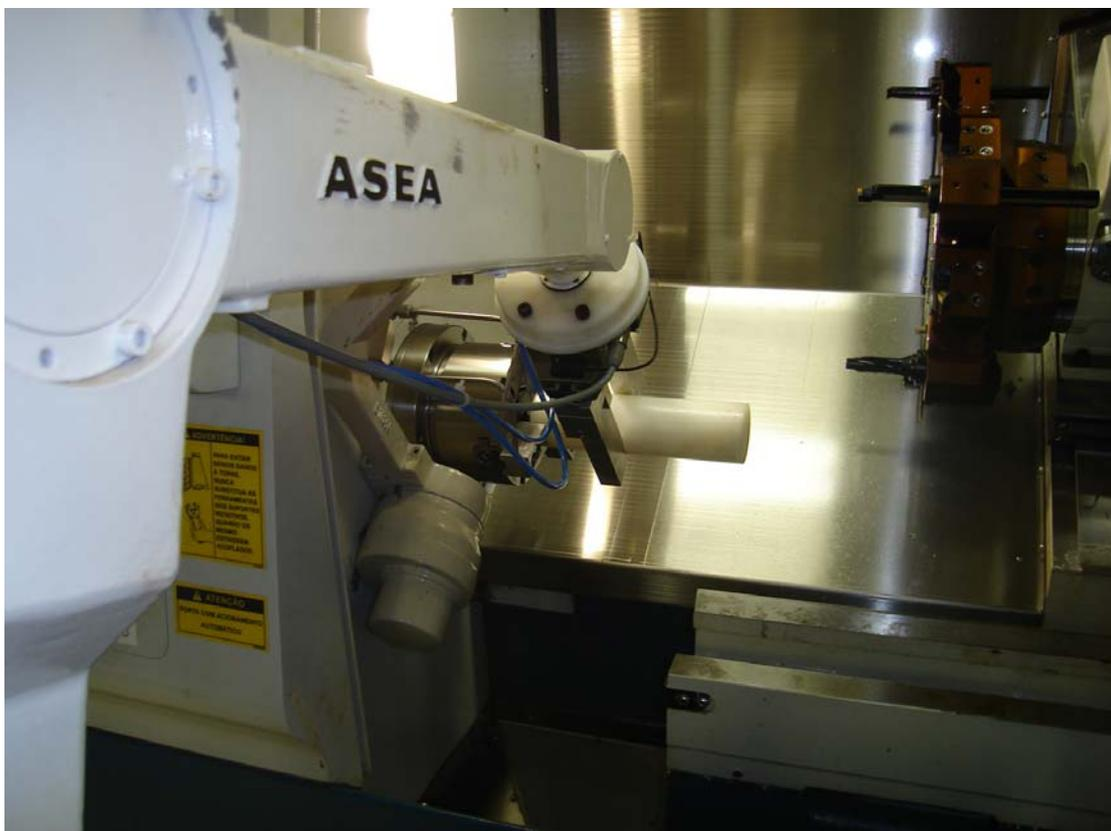
Figura 7.10 - Robô posicionando o *taguro* na placa do Centro de Torneamento.
