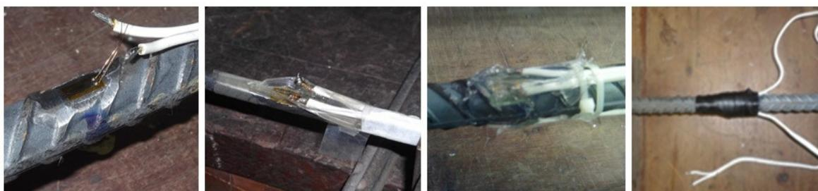
(a) Lixamento/colagem (b) Soldagem dos fios (c) Resina e silicone (d) Fita de autofusão
