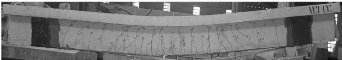
Figura E.11 – Evolução das fissuras da viga VC1 CC
