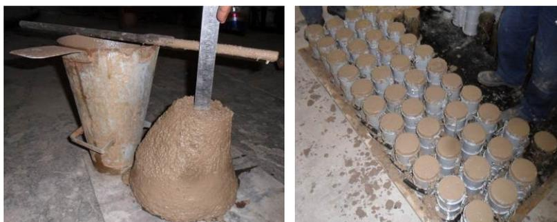
Figura 3.32 - Ensaio do tronco de cone e moldagem dos corpos de prova
