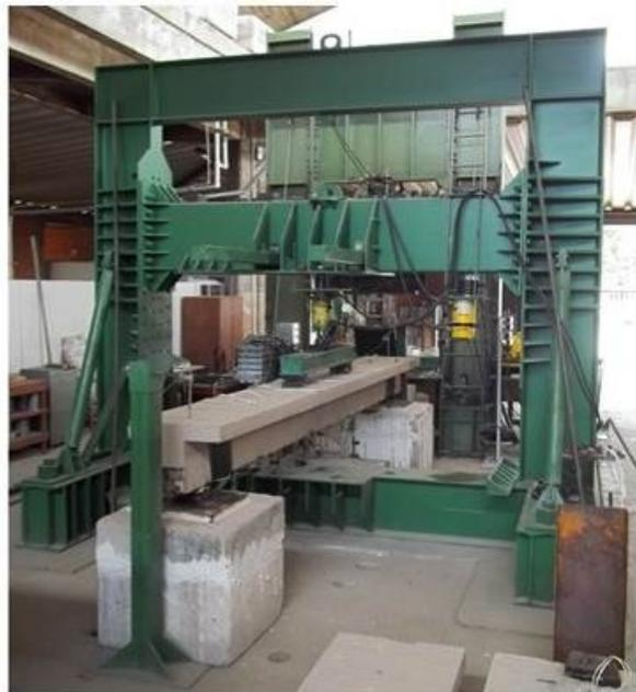
Figura 3.39 – Esquema de ensaio das vigas T
