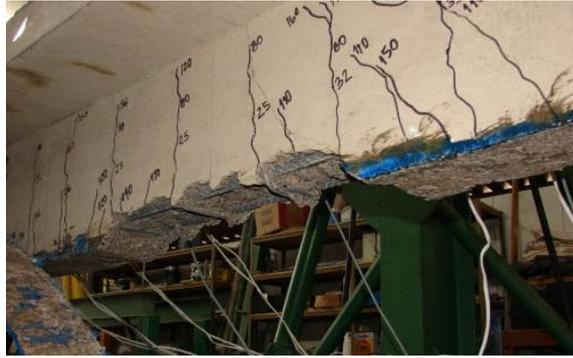
Figura 3.45 - Detalhe da ruptura por destacamento do cobrimento
