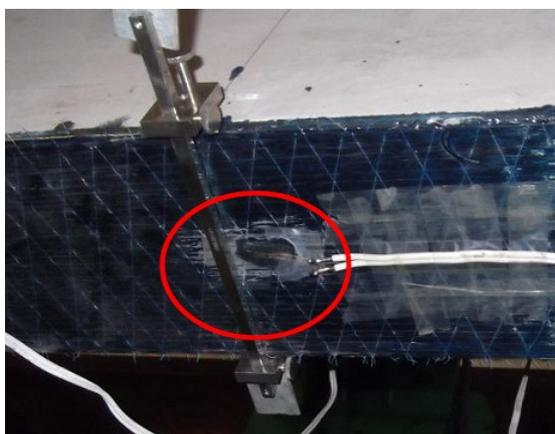
Figura 3.22 - Detalhe da colagem do extensômetro no reforço
