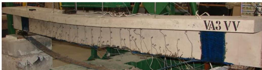
Figura 3.44 - Viga VA3 VV após a ruptura por destacamento do cobrimento
