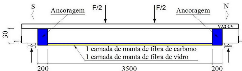
Figura 3.13 - Posicionamento do material compósito longitudinalmente e ancoragem lateral nas extremidades da viga (mm)
