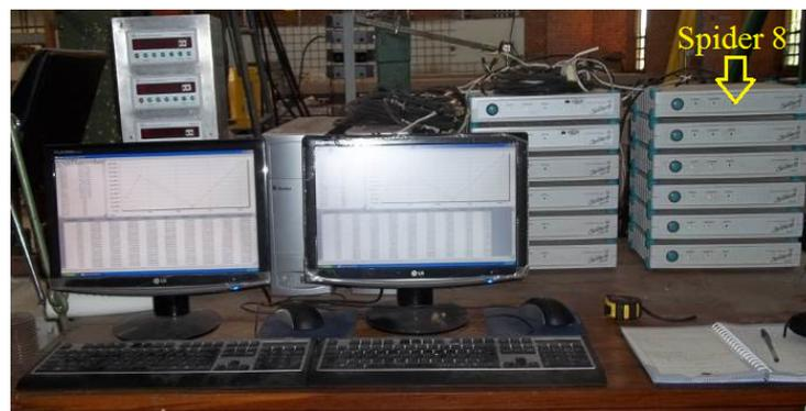
Figura 3.15 - Sistema de aquisição de dados da marca *Spider 8*
