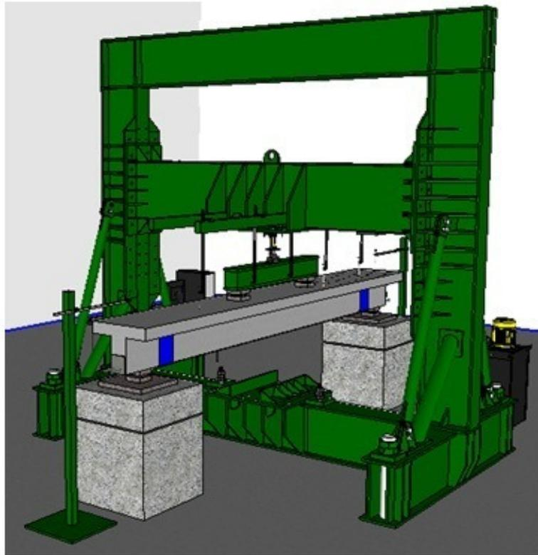
Figura 3.9 – Laje e pórtico de reação com a viga posicionada para ensaio
