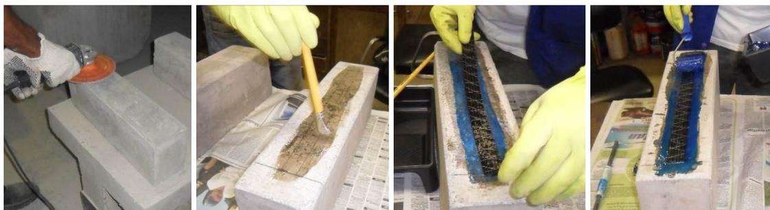
Figura F.2 - Detalhe da preparação dos Prismas: (a) preparo da superfície, (b) aplicação do primer, (c) colocação da fibra e (d) e aplicação do saturante.
