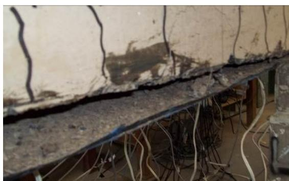
Figura 3.42 – Detalhe da ruptura por descolamento do reforço da viga VA2 CV
