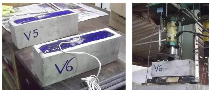
Figura F.3 - Detalhe da instrumentação dos Prismas: (a) deflectômetro mecânico e (b) extensômetro elétrico.
