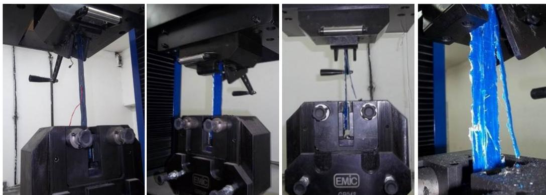
Figura 3.28 - Ensaios de caracterização do PRFV
