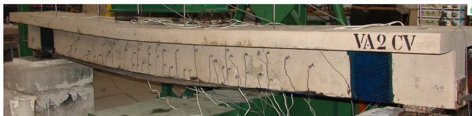
Figura 3.41 - Viga VA2 CV após a ruptura por descolamento do reforço
