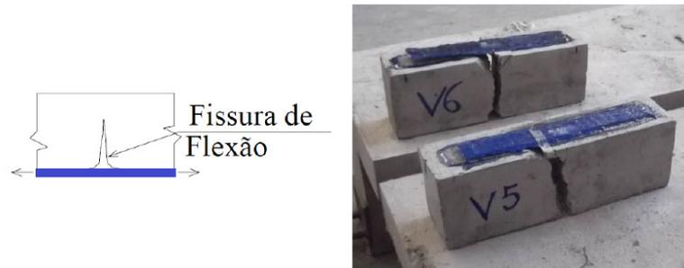
Figura F.4 – Modo de ruptura dos prismas
