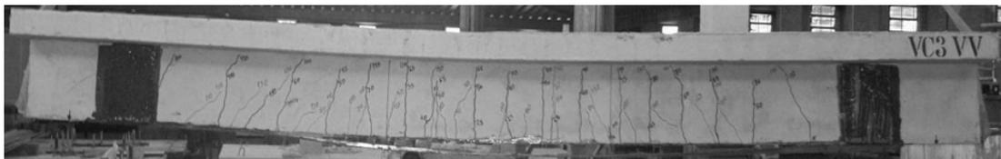
Figura E.13 – Evolução das fissuras da viga VC3 VV
