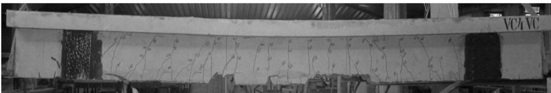
Figura E.14 – Evolução das fissuras da viga VC4 VC
