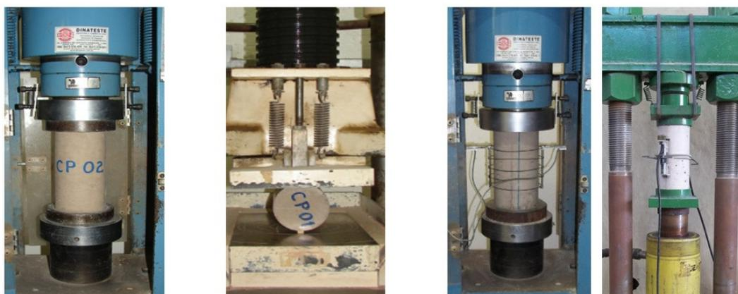
(a) Compressão (b) Compressão diametral (c) Módulo de elasticidade
