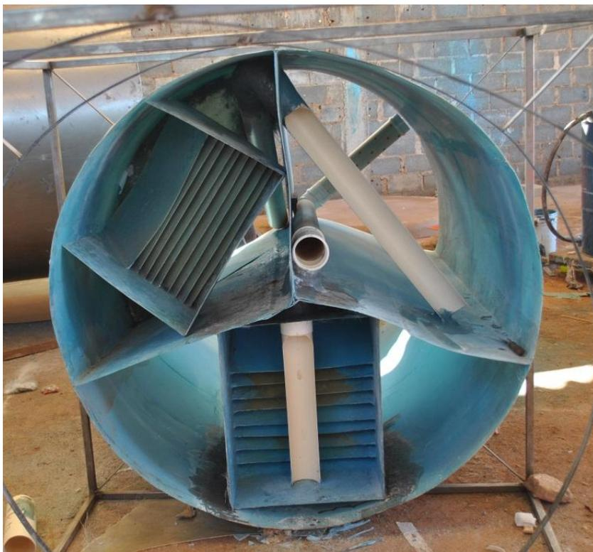
Figura 5.8– (a) Processo de montagem do protótipo, etapa de laminação das peças internas e instalação das canaletas e dos tubos de condução e distribuição; (b) Processo concluído.
