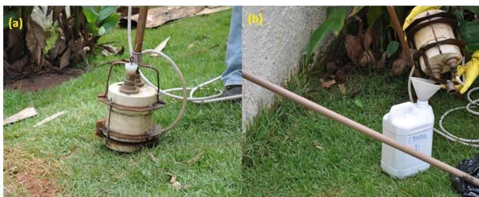
Figura 5.17- (a) Coletor de esgoto bruto; (b) Forma de esgotar o coletor de esgoto bruto.
