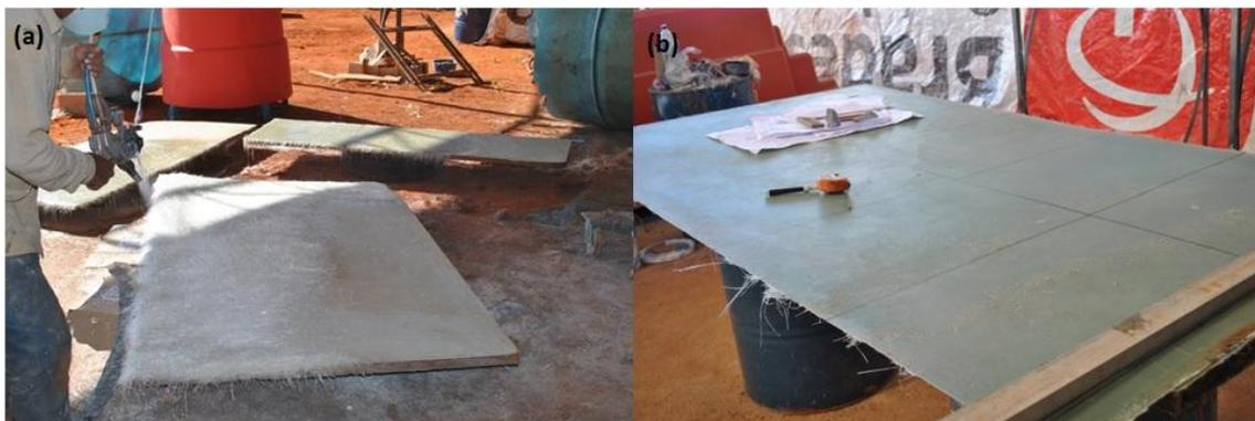
Figura 5.4– Processo de Fabricação, (a) Laminação nos moldes de madeira para confecção das peças internas, (b) Placa de fibra de vidro depois de seca e desenformada.
