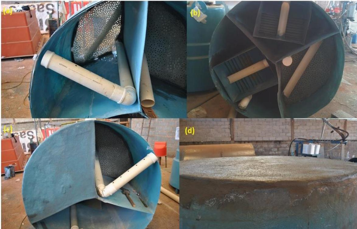
Figura 5.9– Processo de montagem do protótipo, (a) e (b) Etapa de laminação das placas perfuradas, (c) Etapa de laminação das placas do fundo e (d) Reforço do fundo com cimento.
