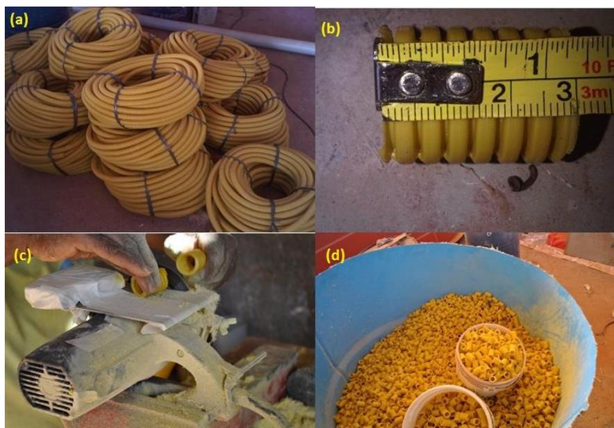
Figura 5.7– Processo de fabricação do meio filtrante, (a) Rolos de conduítes utilizados, (b) Conduíte utilizado, cortado a 3 cm, (c) Conduíte sendo cortado utilizando uma “guia” de madeira adaptada à maquina e (d) Conduítes cortados conforme a especificação.
