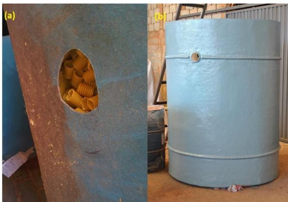
Figura 5.11 – (a) Orifício feito para colocar o recheio na câmara 3; e (b) Protótipo pintado.
