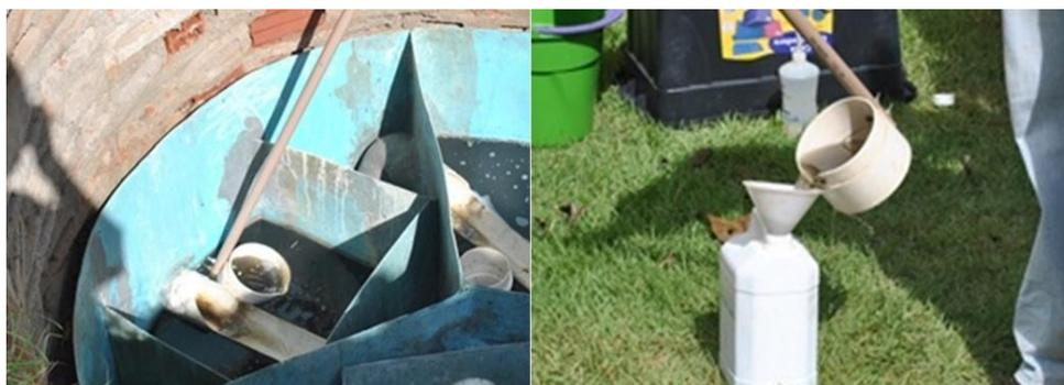
Figura 5.18- Coletor utilizado nos pontos B, C e D.
