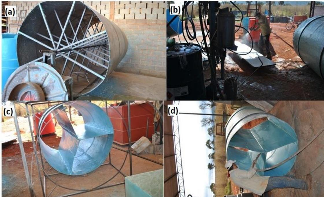
Figura 5.3- Processo de fabricação do protótipo. (a) Cilindro feito de ferro utilizado como molde para base cilíndrica; (b) Pistola de laminação (*Spray-up*); (c) Estrutura circular de ferro; (d) As três placas sendo laminadas concentricamente.
