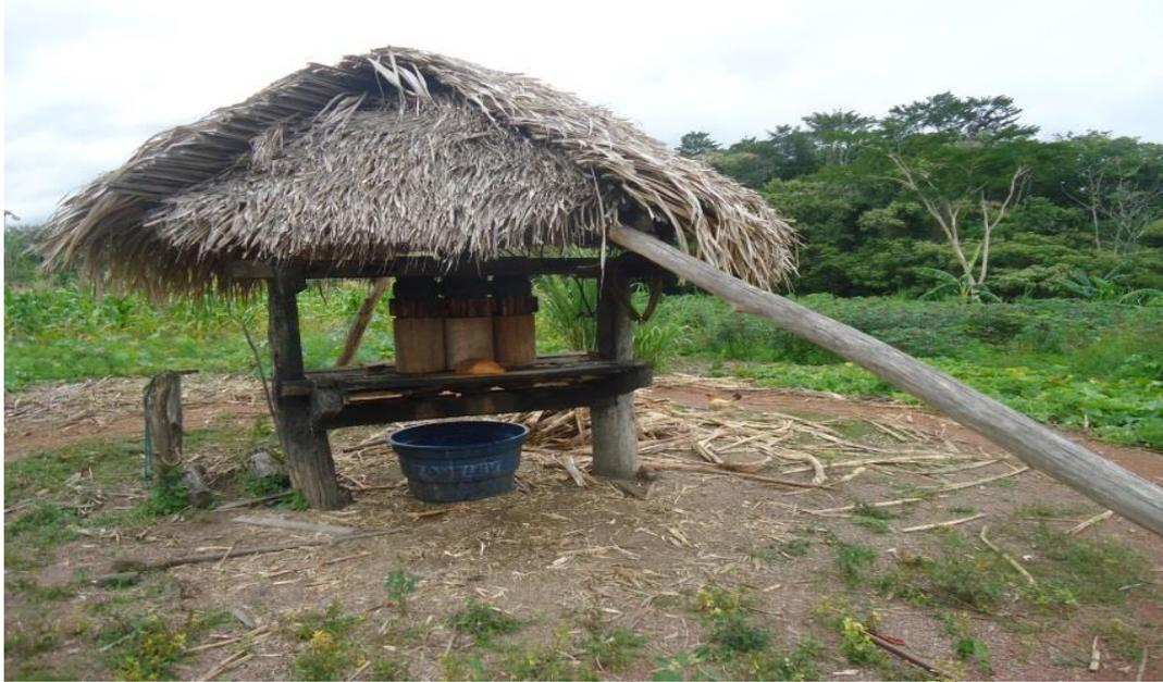
Figura 8: engenho na comunidade Pontezinha. Encontra-se em atividade para a fabricação de rapadura.
