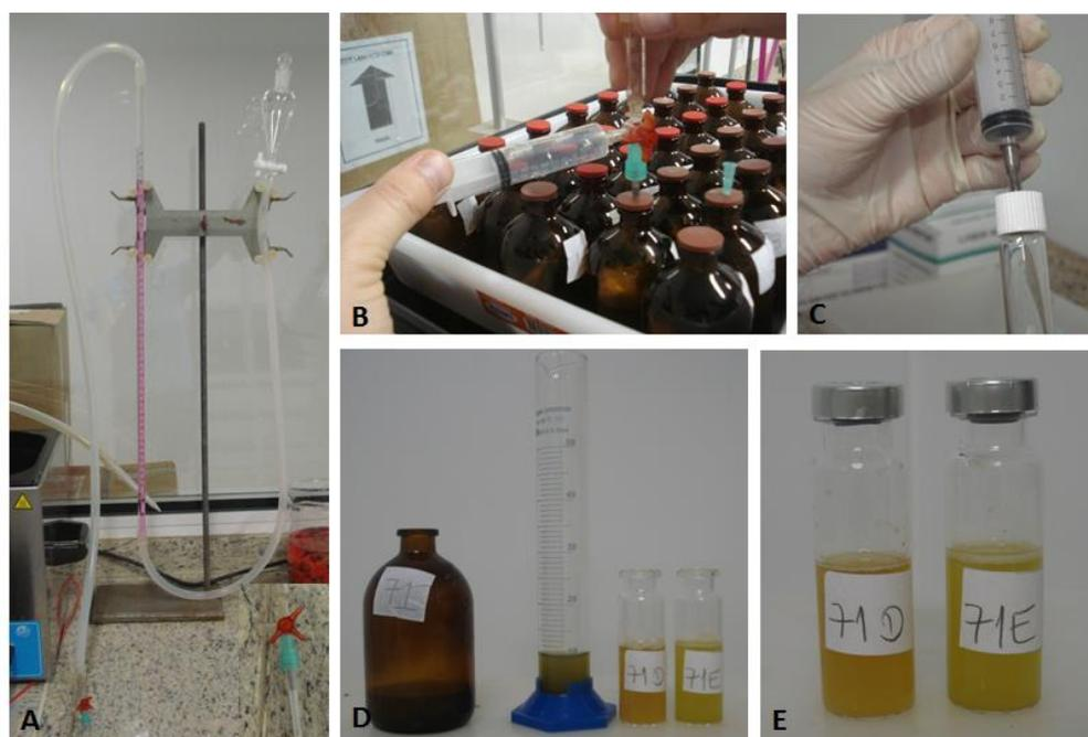
**Figura 2.2.** **A** – aparato de vasos comunicantes; **B** - coleta de gás para mensuração de gás metano; **C** - injeção da amostra de gás em *exetainers* de 6mL; **D** - coleta de 10 mL de solução para avaliação de nitrogênio amoniacal (N-NH<sub>3</sub>) - primeiro frasco - e ácidos graxos voláteis (AGV) - segundo frasco; **E** - frascos lacrados para posterior avaliação.
