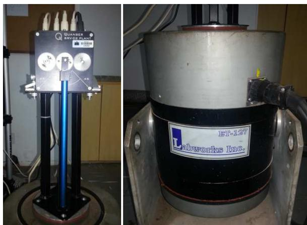
Figura 3.1 – Pêndulo (na esquerda) montado sob uma base fixada ao *Shaker* eletrodinâmico (na direita).
