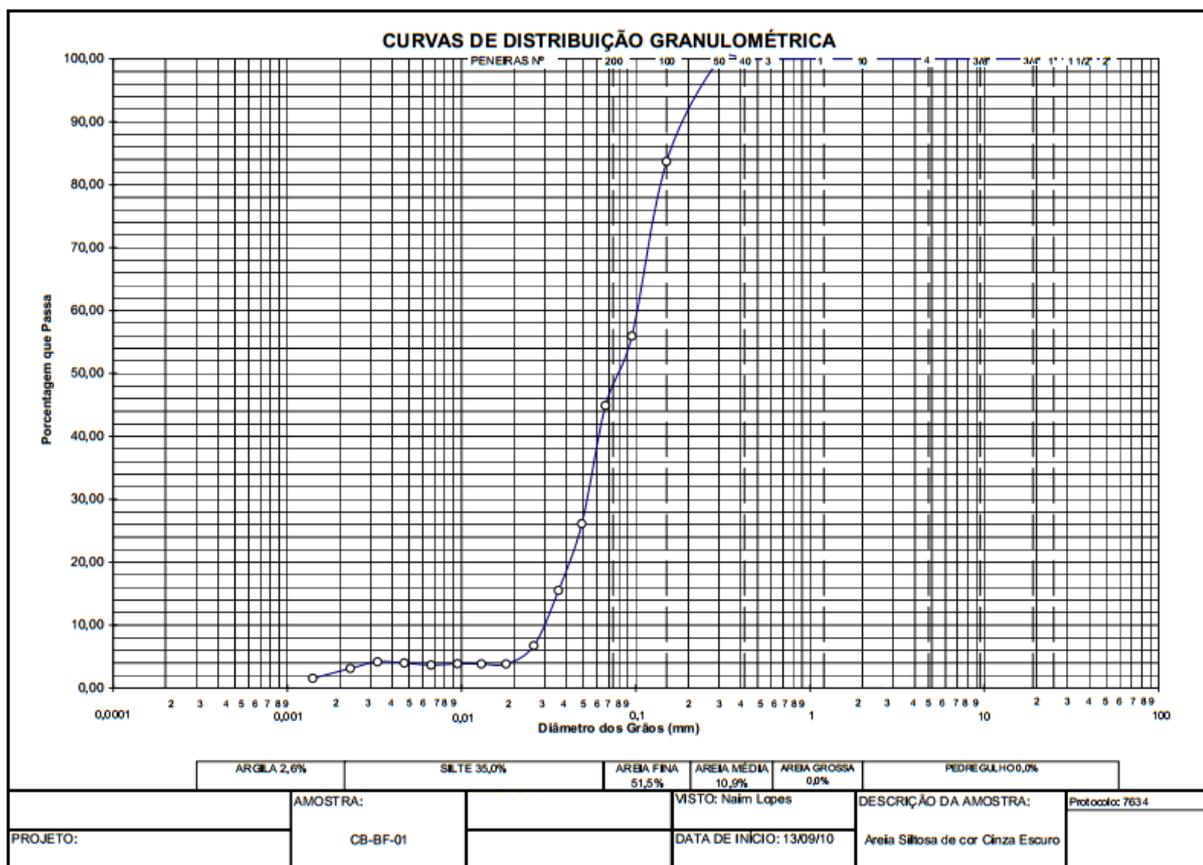
Figura 5.5 – Curva de distribuição granulométrica do *backfill* disposto no FGS 10.2.
