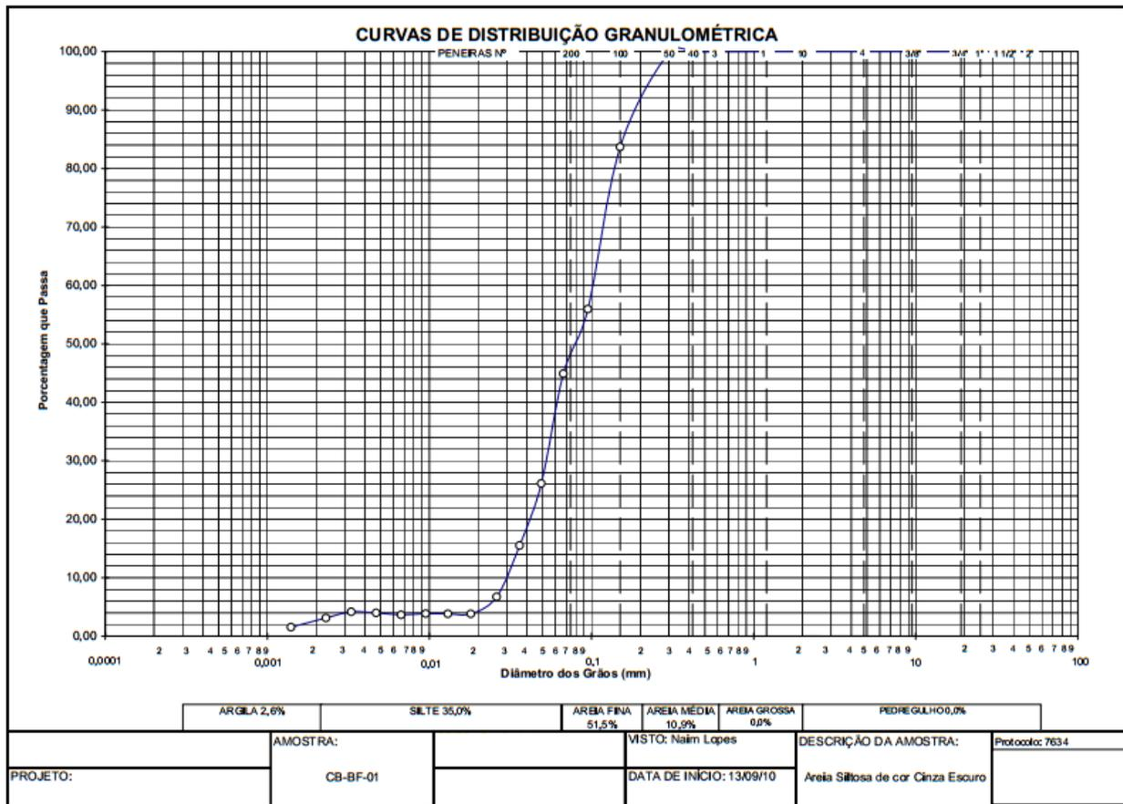
Figura 6.8 – Distribuição granulométrica do *backfill*.
