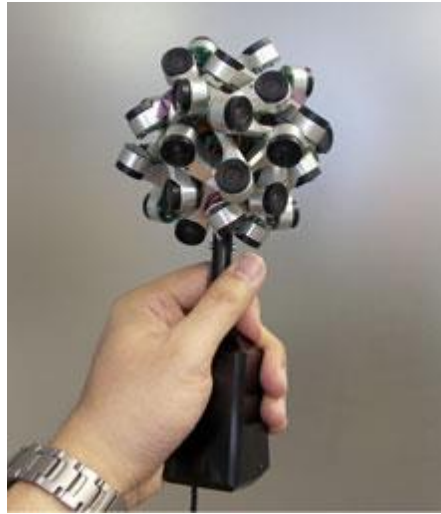
Figura 2.3 - Arranjo com múltiplas câmeras para aquisição de imagens omnidirecionais (Yoda et al , 2006).
