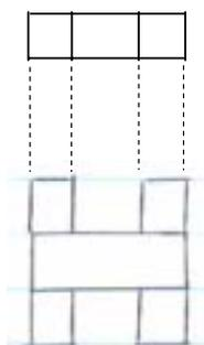
**Figura 4.8.3 – Correspondência adequada entre as vistas superior e frontal.**
