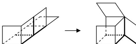
**Figura 4.12.10 – Planificação que resulta em sobreposição de faces.**
