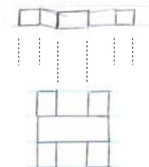
Figura 4.8.2 – Correspondência inadequada entre as vistas superior e frontal.
