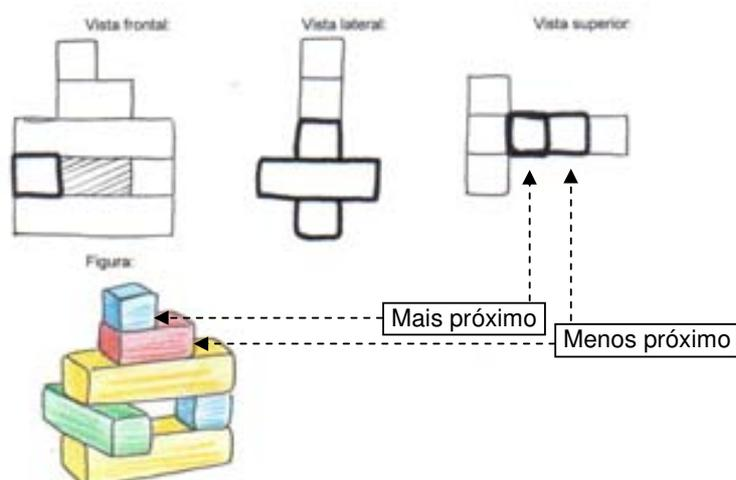
**Figura 4.8.20 – Representação diferenciada das vistas de um sólido.**
