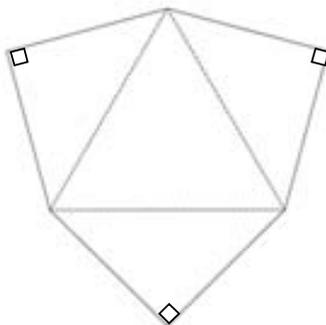
**Figura 4.12.20 – Planificação do tetraedro tri-retangular que forma o vértice do cubo.**
