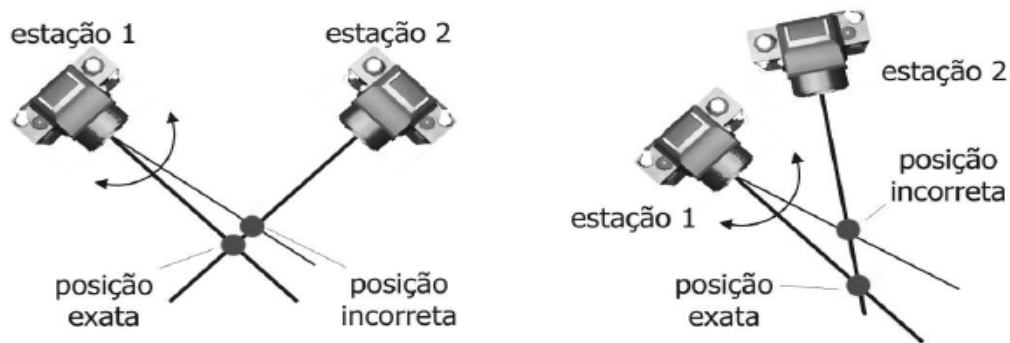
Figura 3. 14- Erro associado às posições da câmara: (a) posição da câmara em estações colocadas perto do ângulo reto; (b) posição da câmara em estações com pouca separação angular (MENDEZ, 2002).
