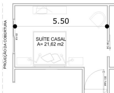
Figura 20 - Exemplo do processo de verificação da aplicabilidade do valor da profundidade-limite do ambiente em relação à altura da janela
